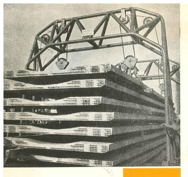
Placas pretensadas apiladas; se ve, en la sección extrema, la distribución de los alambres de la armadura
