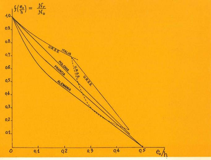
Fig. 5. Relación entre la carga límite en compresión excéntrica y la carga límite en compresión axil.
