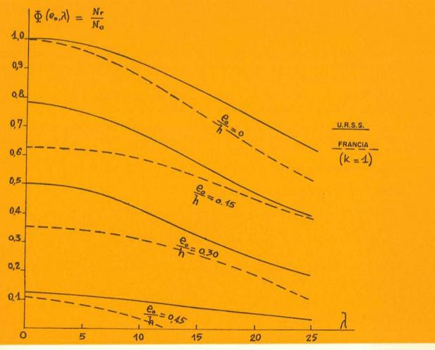
Fig. 7. Cargas límites, en función de la esbeltez, para diversas excentricidades.
