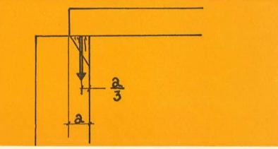
Fig. 1. Distribución de la carga debida al peso propio de un forjado.
