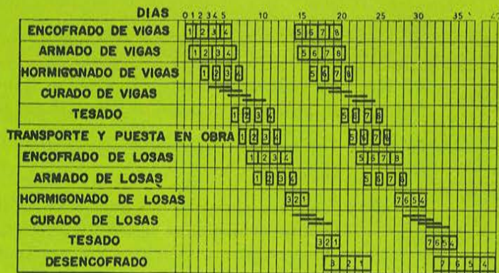
Fig. 9.—Organigrama de las diversas fases relativas a la prefabricación, al transporte y a la puesta en obra de las cuatro vigas de cada tramo y a la construcción del forjado
