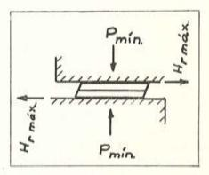
Fig. 20.-Condición límite de deslizamiento.
