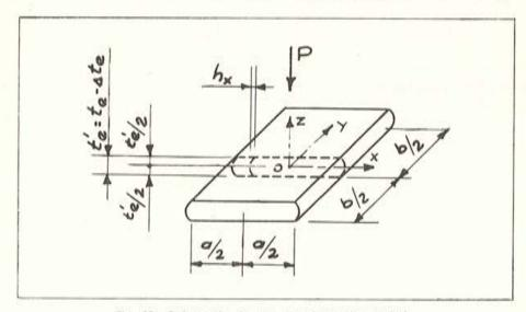
Fig. 22.—Deformación de una capa bajo carga vertical.
