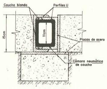
Fig. 1.—Junta neumática.
