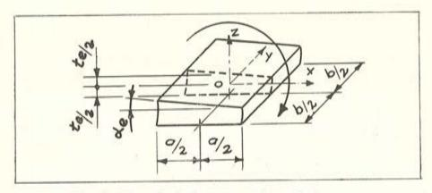
Fig. 25.—Deformación de una capa por efecto del giro.
