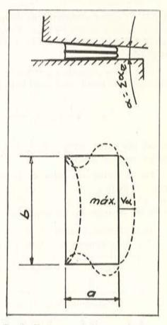
Fig. 9.—Tensiones producidas por el giro α.
