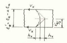
Fig. 24.—Deformación de una capa bajo carga vertical.
