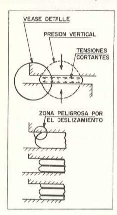
Fig. 4.-Efecto de la combadura.
