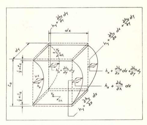
Fig. 23.-Deformación del cubo elemental bajo carga vertical.
