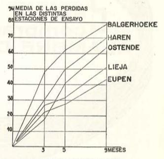
Fig. 8.—Pérdidas en la resistencia a torsión.
