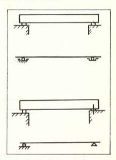
Fig. 3.—Dos tipos fundamentales de sustentación de vigas.
