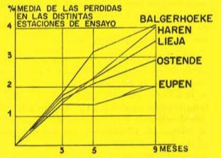
Fig. 6 .- Pérdidas en la resistencia a tracción: Rm.
