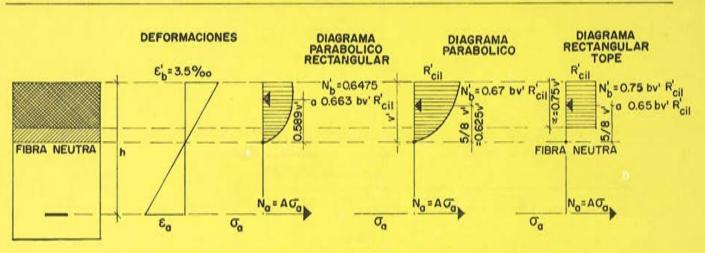
Fig. 1,-Og se deduce del valor de 8g por medio del diagrama tensiones-deformaciones del acero.
