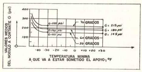
Fig. 15.-Valores aproximados del módulo a cortante.
