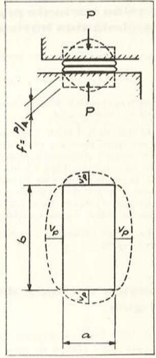
Fig. 6.—Tensiones producidas por la carga vertical P.
