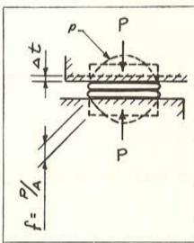
Fig. 11.—Acortamiento producido por la car-
