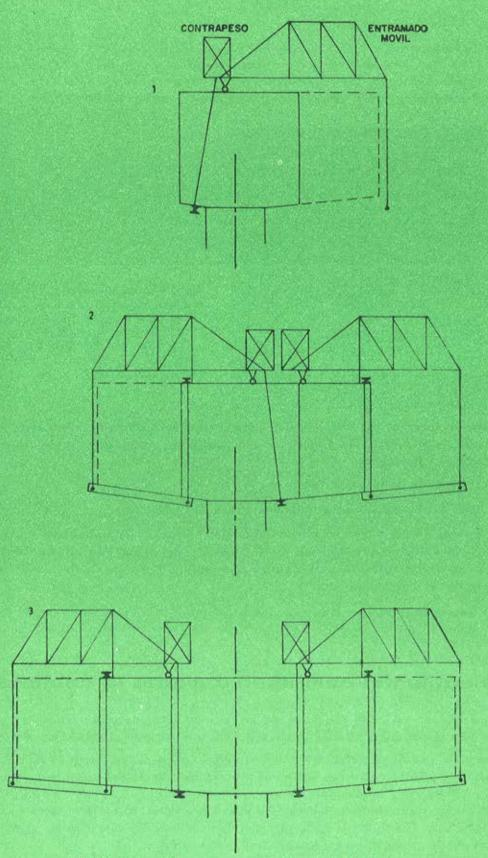
Fig. 16.—Esquema del proceso constructivo de las primeras dovelas.
