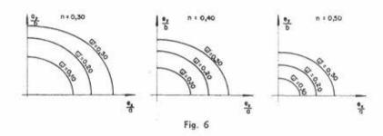
en la construcción de los ábacos, bien debidas a la inexactitud de la interpolación realizada por el computador, bien a errores en la transcripción de las curvas; y sugiere la posible aproximación de la superficie  $\overline{\omega} = \overline{\omega} \left( \frac{ex}{a}, \frac{ey}{b} \right)$  mediante una superficie tronco-cónica cuya expresión analítica podría ser suficientemente sencilla y depender de unos pocos coeficientes que se fijarían con base experimental (\*).
