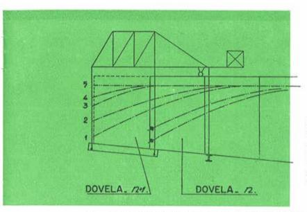
Fig. 15.—Esquema del proceso de ejecución de una dovela. Endurecido el hormigón de la dovela n se tesan los cables que en ella se anclan. Se traslada el entramado móvil, se ajusta el encofrado, se enhebran los cables  $1 \ y \ 2$ , se colocan las vainas para los demás cables, se hormigona la dovela  $n + 1 \ y$ , una vez endurecido el hormigón, se tesan los cables  $1 \ y \ 2$ .
