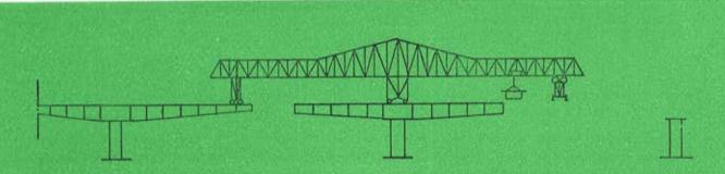
Fig.-22.-Detalle del dispositivo utilizado para la colocación de las dovelas prefabricadas en el puente de l'Ile-d'Oleron (Francia).
