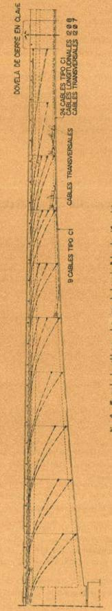
Fig. 9 .- Trazado de cables en el puente de Lacroix-Falgarde (Francia).
