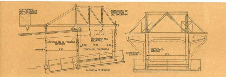
Fig. 11.-Detalle del entramado móvil.
