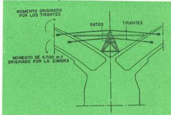
Fig. 2.—Puente de Plougastel: Arranques equilibrados mediante tirantes.
