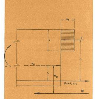
Fig. 6.—Hipótesis de distribución de tensiones en la sección transversal de una pieza, para el cálculo de las deformaciones.
