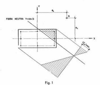
Tenemos, pues, tres parâmetros a determinar (los coeficientes a y b que nos fijan la posición de la fibra neutra, y el valor  $(\varepsilon_b)_{max}$  de la máxima deformación) y otras tantas condiciones a satisfacer, que son las del equilibrio de la sección (una de fuerza y dos de momen-
