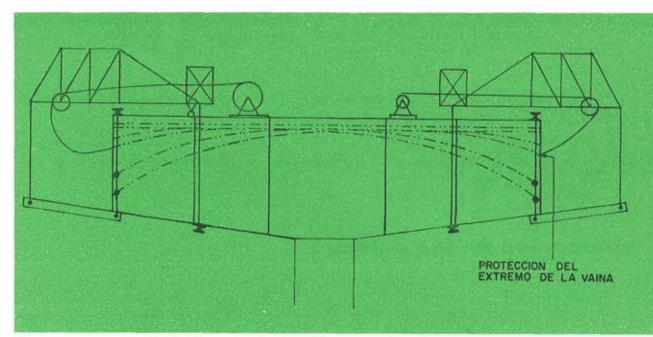
Fig. 14.—Esquema del dispositivo utilizado para enhabrar los cables.
