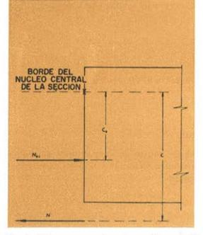
Fig. 4.—Esfuerzos en un elemento sometido a tracción excéntrica (tracción compuesta).
