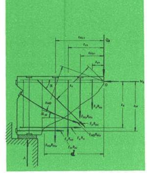
Fig. 2.—Esfuerzos que actúan en la sección inclinada de una viga sometida a csfuerzo cortante, en el estado limite.
