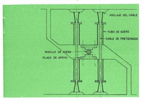
Fig. 4. — Articulación de clave (Puente de Khartoum): Permite la libre dilatación longitudinal del tablero y transmite el esfuerzo cortante.
