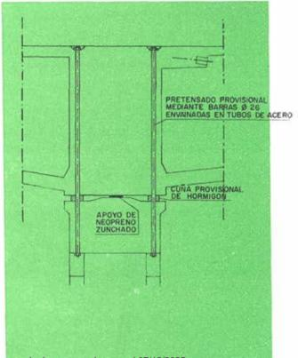
Fig. 10.—Empotramiento provisional de la dovela situada sobre la pila.
