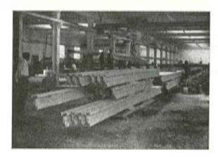
Fig. 3.—Desmoldeo y retirada de los moldes de las viguetas fabricadas.
