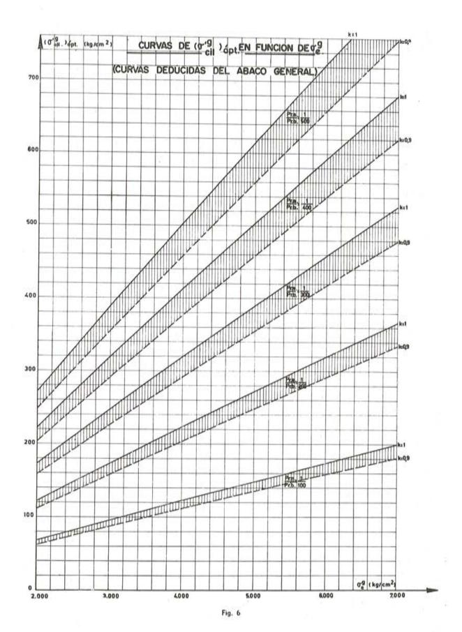
De la observación de la figura 5 se deduce que todos los tipos de hormigón utilizados en la práctica (σ'θ variable entre 100 kg/cm² y 600 kg/cm²) tienen su razón de ser, puesto que son capaces de proporcionar soluciones óptimas, según las condiciones económicas y la calidad del acero adoptado en cada caso.
