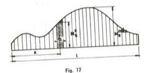
El canto óptimo correspondiente al precio total mínimo de esta porción de viga, se obtiene igualando a cero la derivada de C con respecto a h:
