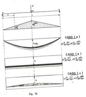
En general, el momento  $M_s$  varía de una sección a otra. Por consiguiente, para que los puntos A y B sigan siendo los mismos en las distintas secciones de la pieza es preciso que h y A varíen de forma continua en función de  $M_s$ , es decir, que las vigas sean de igual resistencia.
