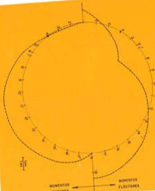
Fig. 34.—Diagramas de momentos elásticos en la pieza con rótulas de torsión en los puntos 4
