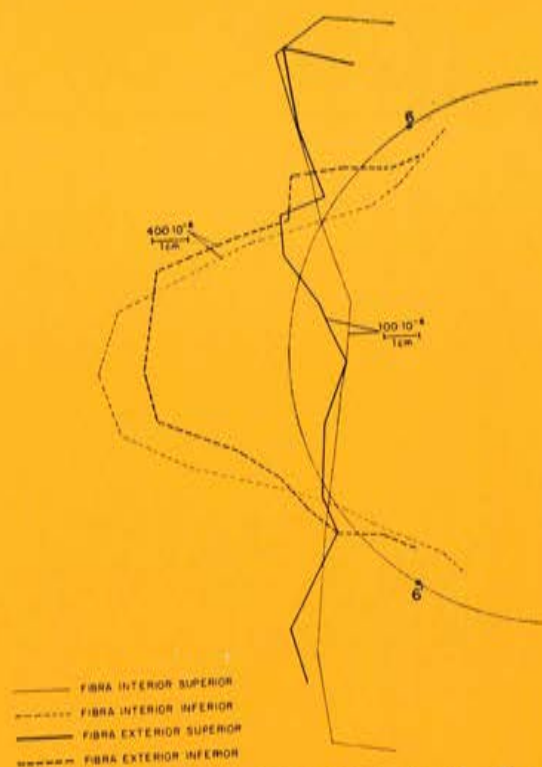
Fig. 27.—Deformaciones zona central (Elongómetro) (fase 4)
