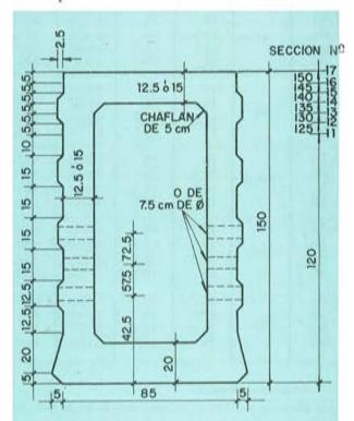
Fig. 1. — Detalle de las vigas tipificadas, de sección en cajón, números 11 a 17. Todas las dimensiones se dan en centímetros.
