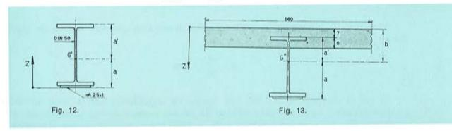
Para el perfil metálico más el hormigón de la cabeza superior, tomando n=10, resulta:
