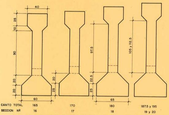
Fig. 1. — Detalle de las vigas tipificadas, de sección en I, números 12 a 20. Todas las dimensiones se dan en centímetros.
