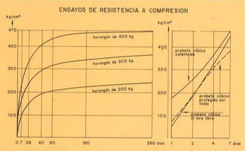
Fig. 1, — Variación de la resistencia a compresión del hormigón. Diagrama de la izquireda: en caso de endurecimiento natural. Diagrama de la derecha: probetas protegidas por toldo; curadas al aire libre y protegidas por un toldo calentado por electricidad. (En todos los casos, la dosificación es la misma.)
