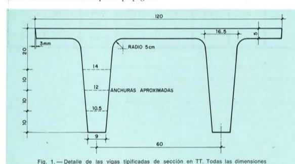
En general, los forjados para pisos construidos a base de estas vigas de sección en TT se completan en obra con una losa superior de 5 cm de espesor. En el caso de forjados para cubierta, el aislamiento necesario puede aplicarse directamente sobre la superficie superior de las piezas prefabricadas. Con frecuencia se hace preciso disponer algún tipo de enlace mecánico, entre los bordes de las distintas piezas, en las secciones situadas a los tercios o a los cuartos de la luz.
