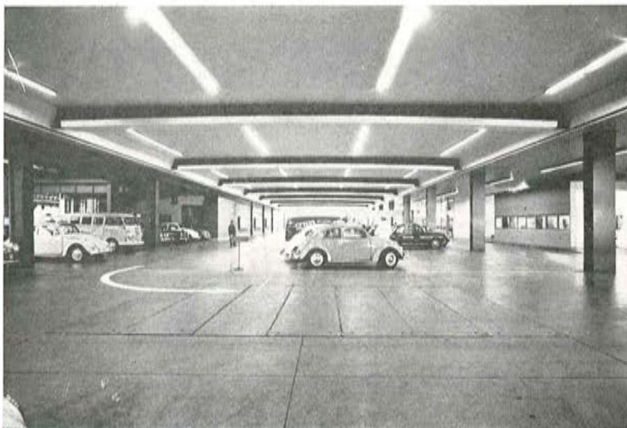
Nuevo edificio de la firma "Ieteren Frères", en Bruselas. Se utilizaron 42 vigas PREFLEX de luces comprendidas entre 8 y 18,10 m.
