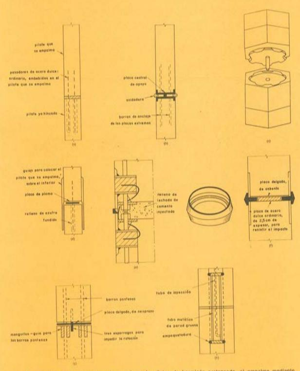
Fig. 5. — Detalles de diversos tipos de empalmes de pilotes de hormigón pretensado, a) empalme mediante pasador y junta epoxi (Estados Unidos, Noruega); b) empalme por soldadura; c) empalme por soldadura (patente japonesa); f) empalme tipo "Brunsplice" (patente norteamericana); g) empalme mediante postensado (Gran Bretaña); h) empalme mediante tubo de acero en pilotes huecos (Noruega).
