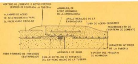
Fig. 1. — Sección-tipo de una tubería cilindrica, de homigón pretensado, con camisa exterior de chapa.
