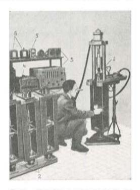
Fig. 6. — Dispositivo para los ensayos de relajación según el método de medida de la
