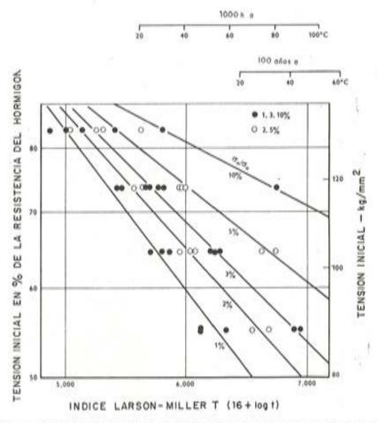
Fig. 5. — Diagramas de relajación  $(\sigma_n)$  correspondientes a alambres sometidos a tratamiento térmico, para distintos valores de la tensión inicial, temperatura y duración del ensayo.
