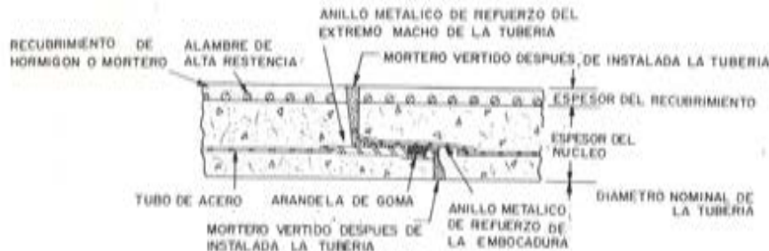
Fig. 2.— Sección-tipo de una tubería cilíndrica, de hormigón pretensado, con camisa metálica intermedia.
