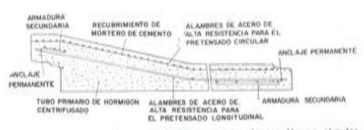
Fig. 3. — Sección-tipo de una tubería compuesta, de sección no circular,
