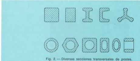
precisan de armaduras transversales adicionales. En comparación con los postes en I, acanalados, Vierendeel y de otras secciones, los postes de hormigón pretensado de sección transversal circular hueca y armaduras colocadas simétricamente en su periferia, ofrecen las siguientes ventajas:
