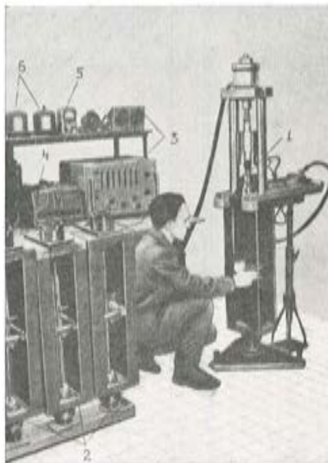
Fig. 6. — Dispositivo para los ensayos de relajación según el método de medida de la frecuencia de la vibración transversal. 1, dispositivo de carga, para equipos pequeños de ensayo, provisto de gatos hidráulicos y dinamómetros; 2, grupo de marcos de carga para probetas obtenidas de cables de 15 mm de diámetro; 3, computador electrónico para medir las frecuencias y dispositivo de accionamiento; 4, amplificador; 5, dispositivo para medir el esfuerzo inicial; 6, termómetro o higrómetro registradores.
