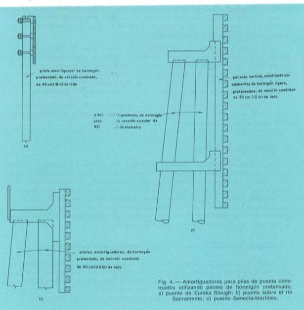
veniente, a lo largo de la vida de servicio de la propia estructura, no requieren un coeficiente de seguridad tan elevado como los pilotes de cimentación.
