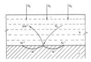
Fig. 1. — Representación esquemática de la corrosión, según el proceso denominado "par eléctrico local", a = aire; b = electrólito; c = metal.
