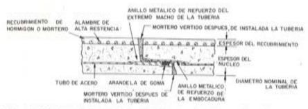
Fig. 2. — Sección-tipo de una tubería cilíndrica, de hormigón pretensado, con camisa metálica intermedia.
