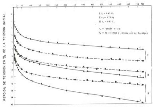
Fig. 1. — Diagramas característicos de relajación para alambres de alta resistencia, de 5 mm de diámetro, ensayados a temperatura normal. 1, estirados en frío; 2, normalizados.
