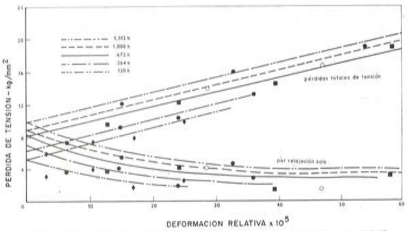
Fig. 8. — Influencia de la retracción y fluencia de una estructura, sobre las pérdidas por relajación.
