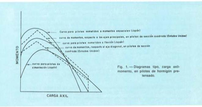
En la cabeza del pilote, donde la acción combinada del momento y la carga axil puede ser crítica, deberá tenerse en cuenta la influencia favorable de la longitud de transmisión (es decir, que el valor del esfuerzo efectivo de pretensado sobre el hormigón varía desde 0 hasta su valor total, sobre dicha longitud de transmisión).
