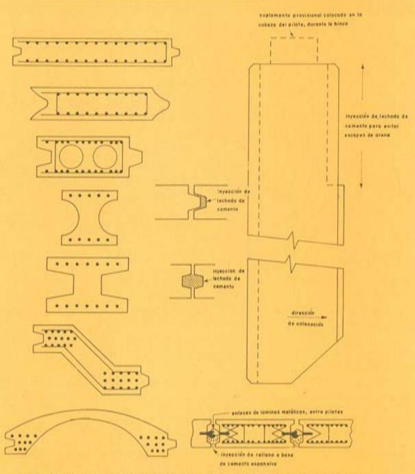
Fig. 2. — Detalles y secciones transversales típicas de las tablestacas de hormigón pretensado,
