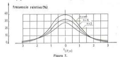
dent, tienden hacia la curva de Gauss cuando n tiende a infinito. Los valores de  $t_{(P,n)}$  vienen dados en función de P y de n en la tabla de Student. La figura 8 muestra como ejemplo la evolución de  $t_{(P,n)}$  en función de n, para P=68,2, 80, 90, 95, 99 y 99,9 por 100. Para cualquier valor de P,  $t_{(P,n)}$  tiende hacia  $t_{(P)}$  cuando n aumenta.
