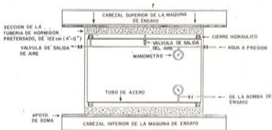
Fig. 13. — Dispositivo para el ensayo de tuberías de hormigón pretensado sometidas a la acción combinada de cargas externas y presión hidráulica.
