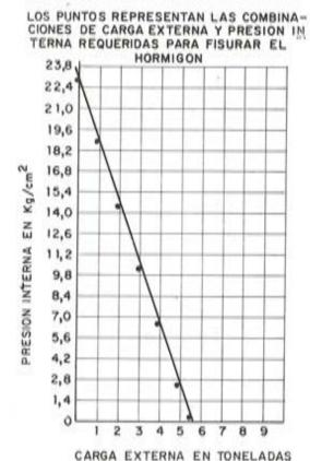
Fig. 14. — Ensayo de una tubería de hormigón pretensado, de 84 cm de diámetro, bajo la acción combinada de carga externa y presión interna.
