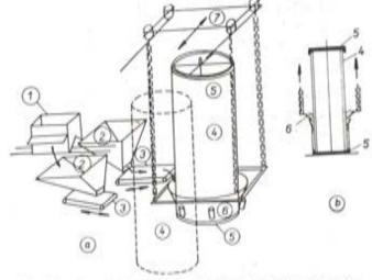
Fig. 9. — Esquema de la aplicación de la capa de recubrimiento. 1, carretilla para el transporte del hormigón fresco; 2, tolvas: 3, cinta transportadora; 4, tubería con la armadura helicoldal ya dispuesta para su recubrimiento; 5, tapas extremas provisionales; 6, dispositivo móvil, sujeto por poleas, para el vertido del hormigón.
