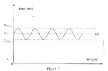
Sin embargo, la mayoría de los factores — como, por ejemplo, los esfuerzos parásitos, la concentración de tensiones, los efectos de entalladura, las variaciones de temperatura y los agentes corrosivos — son capaces de disminuir notablemente la resistencia a fatiga de las estructuras.
