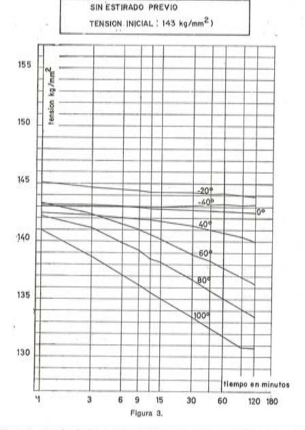
En la figura 3, tomada de la comunicación presentada por Dumas, se puede apreciar el aumento de relajación en función de la temperatura.
