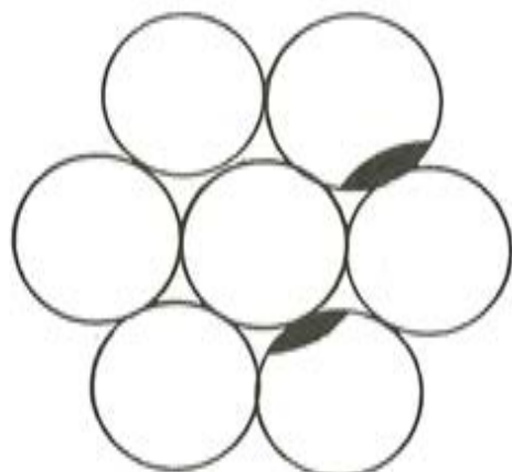
Fig. 19. — Esquema de la rotura de cables por fatiga.
