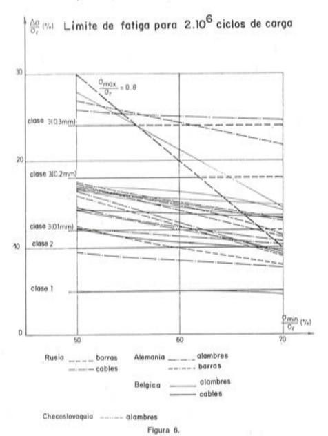
coslovaquia y Bélgica. Se ha comprobado que la zona cubierta por los diferentes tipos de acero es muy importante, así como la evolución de los límites de fatiga en función de  $\sigma_{\min}$ . La inmensa mayoría de las armaduras cumplen fácilmente las condiciones más severas de la clase 2.
