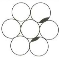
Fig. 19. — Esquema de la rotura de cablea por fatiga.
