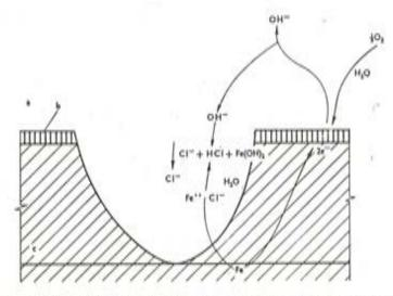
Fig. 2. — Representación esquemática de los procesos asociados con la corrosión por picadura, a = electrólito; b = capa pasiva; c = metal.
