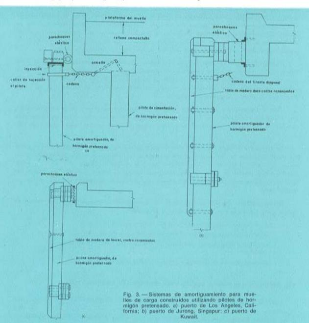
Los pilotes construidos con hormigón de áridos ligeros resultan idóneos para su utilización como amortiguadores, norayes, duques de alba, etc., porque admiten una gran flecha y absorben gran cantidad de energía.
