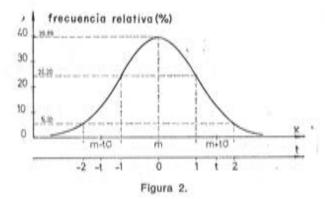
Frecuentemente sucede que esta ley de distribución es simétrica y obedece a la ecuación de Laplace-Gauss; se dice entonces que la distribución del conjunto es "normal" y esa distribución viene definida totalmente por la media m y por la desviación tipo  $\sigma$  (figura 2).
