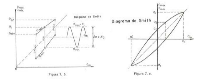
aceros mejorados, 4 aceros estirados en frío, con o sin revenido y un acero patentado, ofrecen valores para L  $F_{\mathfrak{S}_{adm}}$  que oscilan entre 23 y 50 kg/mm², con curvas de aspecto muy distinto para  $\sigma_{adm}=0.55\,\sigma_{r}.$
