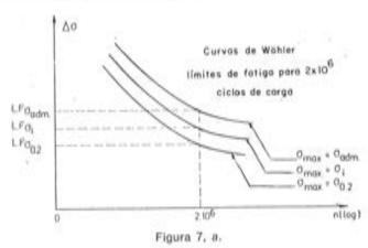
Los ensayos citados por Rehm y Russwurm han sido realizados sobre 16 tipos de armaduras, y demuestran que L F  $_{\mathfrak{I}_{adm}}$  es siempre mayor que L F  $_{\mathfrak{I}_{0,2}}$ , y que la diferencia L F  $_{\mathfrak{I}_{adm}}$  — L F  $_{\mathfrak{I}_{0,2}}$  oscila entre 22 kg/mm² y 0, según los tipos de acero, sin que se pueda establecer una relación entre esta diferencia y las otras características del acero.
