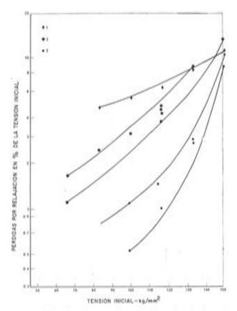
Fig 3. — Pérdidas por relajación, de tres tipos distintos de alambre, obtenidas en ensayos a mil horas y a 20° C. 1, estirado en frío; 2, normalizado; 3, estabilizado.
