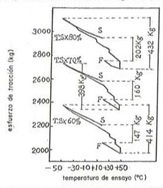
Fig. 7. — Influencia de la variación de temperatura sobre el esfuerzo de tracción. S, principlo del ensayo; F, final del ensayo; T.S., tensión de rotura.
