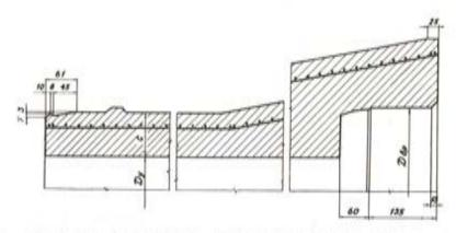
Fig. 4. — Sección-tipo de una tubería, de hormigón pretensado, fabricada por vibrocompresión.
