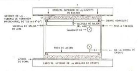
Fig. 13. — Dispositivo para el ensayo de tuberías de hormigón pretensado sometidas a la acción combinada de cargas externas y presión hidráulica.
