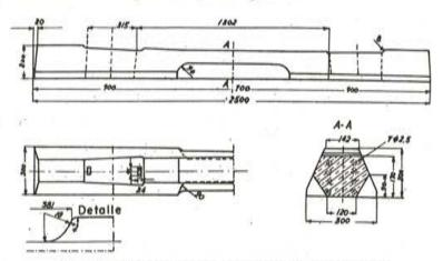
Fig. 1. — Traviesa de hormigón pretensado tipo JKBK-75.
