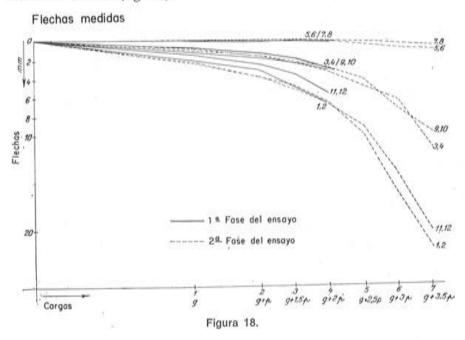
La magnitud del esfuerzo inicial de pretensado introducido se midió con un dinamómetro, no admitiéndose deslizamiento alguno en los anclajes. En el modelo se dispusieron diversos flexímetros (17 en total) para poder medir las flechas longitudinales y transversales. Además, en el hormigón se colocaron 72 elongámetros (unos independientes y otros formando rosetas), y 88 en las armaduras y cables.
