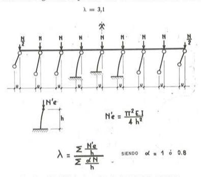
Fig. 18. - Estabilidad al pandeo de la estructura continua.
