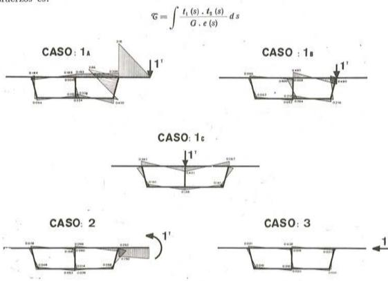
Fig. 10. - Momentos flectores transversales bajo ciertos estados de carga.
