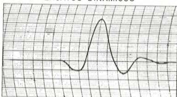
Fig. 97. — Registro de los flexímetros a lo largo del ensayo dinámico.
