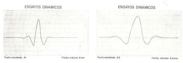
Fig. 95. - Registro de los flexímetros a lo largo del ensayo dinámico.
