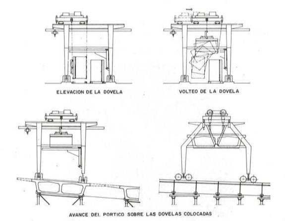
Fig. 64. — Esquema del funcionamiento del pórtico de transporte, y colocación
