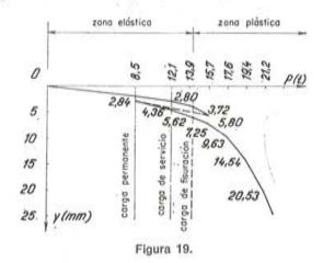
carga permanente (g) y de una sobrecarga (p) que se iba aumentando gradualmente hasta alcanzar la fisuración. Después se descargó el modelo y se volvió a someter a un proceso de carga, análogo al anterior, hasta llegar a la rotura. La presencia de fisuras se detectó por el método de las ondas ultrasónicas.
