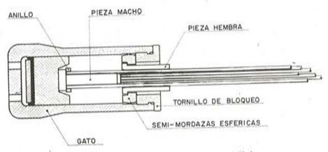
Fig. 75. — Gato de acoplamiento (peso, 15 Kg).
