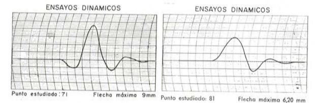
Fig. 97. — Registro de los flexímetros a lo largo del ensayo dinámico.
