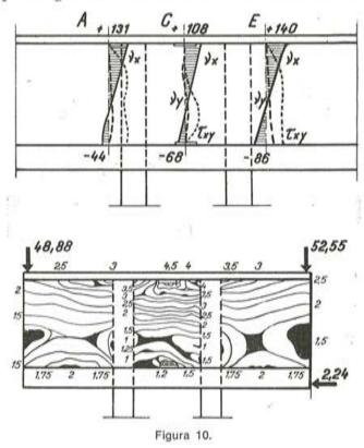
la pila y volviendo después a unirlas. Se comprobó que las tensiones máximas en la pila se producen bajo el borde exterior de la sección en cajón del tramo. En la estructura real, estas tensiones eran de 130 kp/cm<sup>2</sup>.
