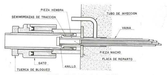
Fig. 76. - Gato de pretensado (peso, 25 Kg.).
