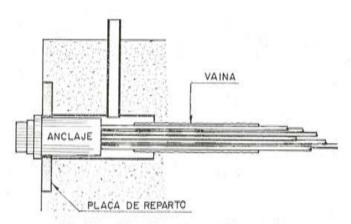
Fig. 78. — Dispositivo para anclaje muerto.
