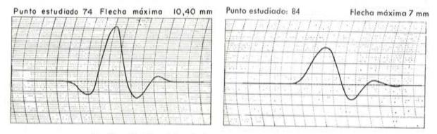
Fig. 98. — Registro de los flexímetros a lo largo del ensayo dinámico.
