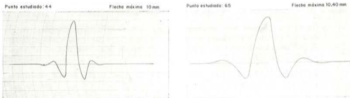
Fig. 96. — Registro de los flexímetros a lo largo del ensayo dinámico.
