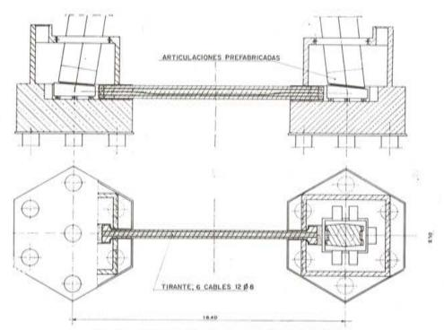
Fig. 48. — Esquema de las zapatas de cimentación.
