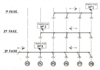
Fig. 30. — Esquemas estáticos de la estructura a lo largo de su construcción.
