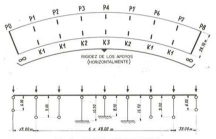
Fig. 15. - Esquema estático del tablero.
