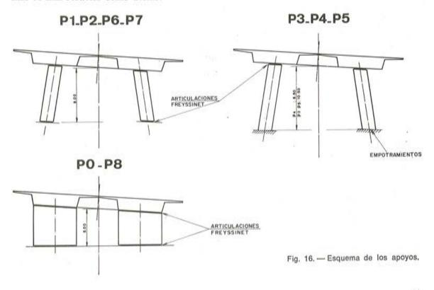
a) En dirección transversal, los pórticos son de rigidez variable; así en P0 y P8 existen pórticos (placas macizas) de rigidez infinita; en P3, P4 y P5, los pórticos son de gran rigidez (K2 y K3), y los pórticos P1, P2, P6 y P7 tienen una rigidez media (K1).
