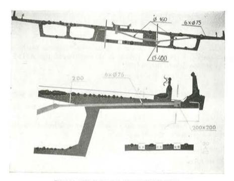
Fig. 99. — Esquema de la evacuación de aguas.
