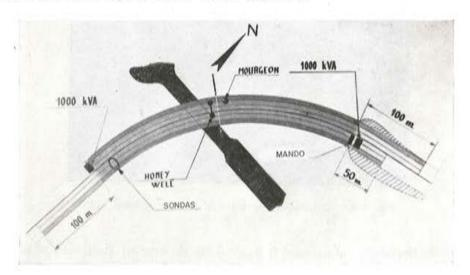
Fig. 106. — Esquema general de calefacción. Las distintas vías de circulación van sombreadas según las potencias unitarias instaladas. La más oscura corresponde a 250 W./m.².
