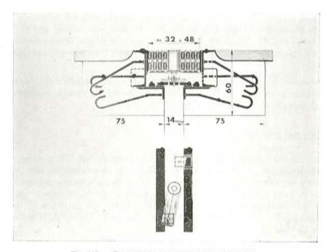
Fig. 100. — Esquema de la junta del tipo ROB F 160.
