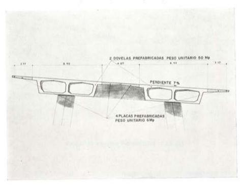
Fig. 21. — Descomposición de la obra en elementos prefabricados,
