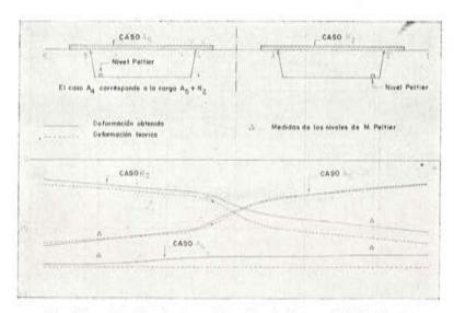
Fig. 94. — Sección transversal media del tramo P5-P6, Flexión disimétrica.
