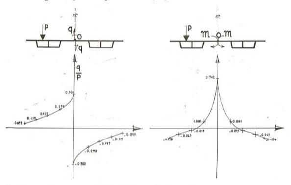
Fig. 13. — Línea de influencia del esfuerzo cortante en el centro de la losa (caso de viga continua).
