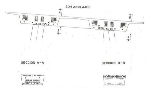
Fig. 28. - Anclajes, en las riostras, de los cables longitudinales del trablero.
