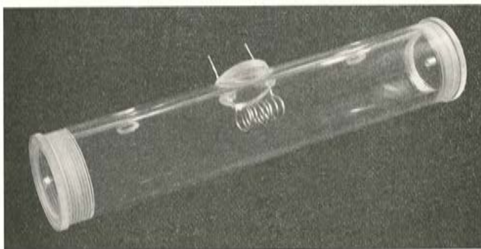
Fig. 4-b.—En este tipo de célula de corrosión, el arrollamiento tiene como finalidad introducir una polarización arbitraria en el alambre.
