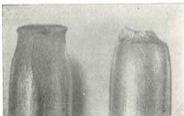
Fig. 13, b . — Acero patentado y trefilado. Rótura dúctil (provocada en una máquina de tracción) después de estar sometido al mismo ambiente agresivo ( \times 12 ).
