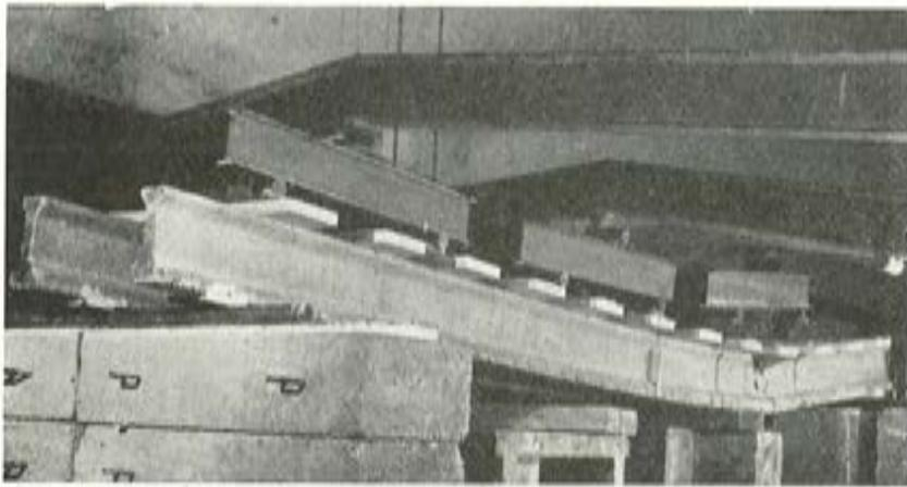
Fig. 1. — Ensayo de un par de viguetas resistentes.
