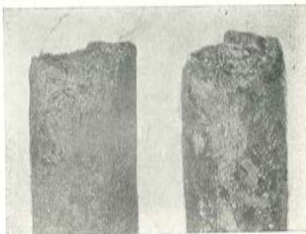
Fig. 13, a. — Acero templado y revenido. Ruptura frágil, por corrosión bajo tensión, debido a nitratos ( \times 12 ).
