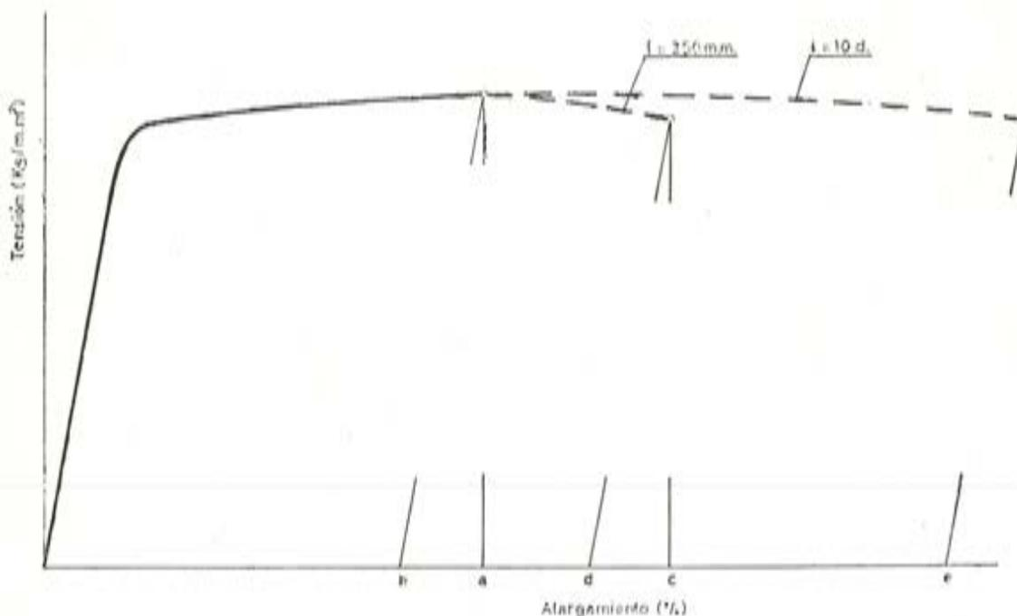
Fig. 3.—Diversas mediciones del alargamiento de rotura.
