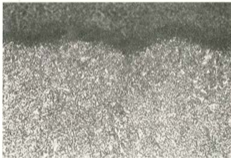
Fig. 3-b.—Estructura de un alambre templado y revenido (bonificado). Obsérvese que no hay orientación preferente y que la superficie del borde es más rugosa.
