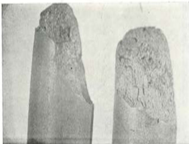
Fig. 20, a. — Acero patentado y trefilado. Rotura por fragilización por hidrógeno ( \times 12 ).
