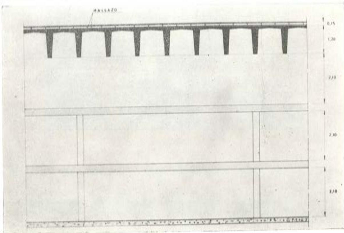
La solución de vigas con sección TT se ha revelado como muy interesante. Aunque desde un punto de vista estrictamente mecánico constituyen secciones poco convenientes para una pieza con armaduras pretensas, ya que su módulo resistente superior es del orden del doble que el inferior, su facilidad de fabricación y el gran espacio cubierto en planta las hacen interesantes en conjunto. Esta ventaja crece con el ancho y por este motivo se
