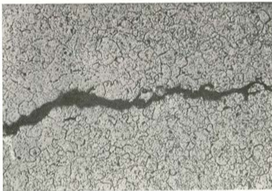
Fig. 14.—Grieta producida por corrosión, bajo tensión debida al ataque de nitratos, en un alambre templado y revenido. Aumentos, \times 300 .
