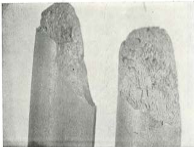
Fig. 20, a. — Acero patentado y trefilado. Rotura por fragilización por hidrógeno ( \times 12 ).
