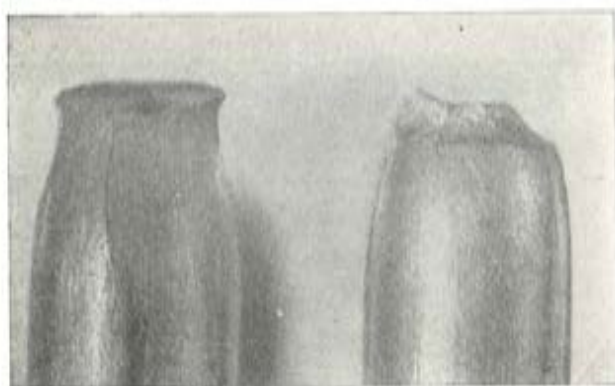
Fig. 13, b. — Acero patentado y trefilado. Ruptura dúctil (provocada en una máquina de tracción) después de estar sometido al mismo ambiente agresivo ( \times 12 ).
