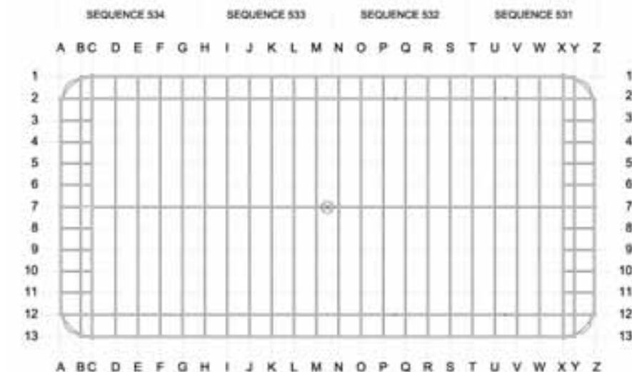
Figura 2. Sección horizontal de la estructura hasta la cota +13.00 desde nivel de dique seco. Celdas doble casco con muros exteriores de 0,6m. de espesor. Muros medianeros de 0,45m. Figure 2. Horizontal cross section up to elevation +13.00, from dry dock level. Dual-hull cells with 0.6 m. thick outside walls. 0.45 m thick party walls.
