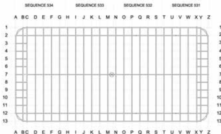
Figura 2. Sección horizontal de la estructura hasta la cota +13.00 desde nivel de dique seco. Celdas doble casco con muros exteriores de 0,6m. de espesor. Muros medianeros de 0,45m. Figure 2. Horizontal cross section up to elevation +13.00, from dry dock level. Dual-hull cells with 0.6 m. thick outside walls. 0.45 m thick party walls.
