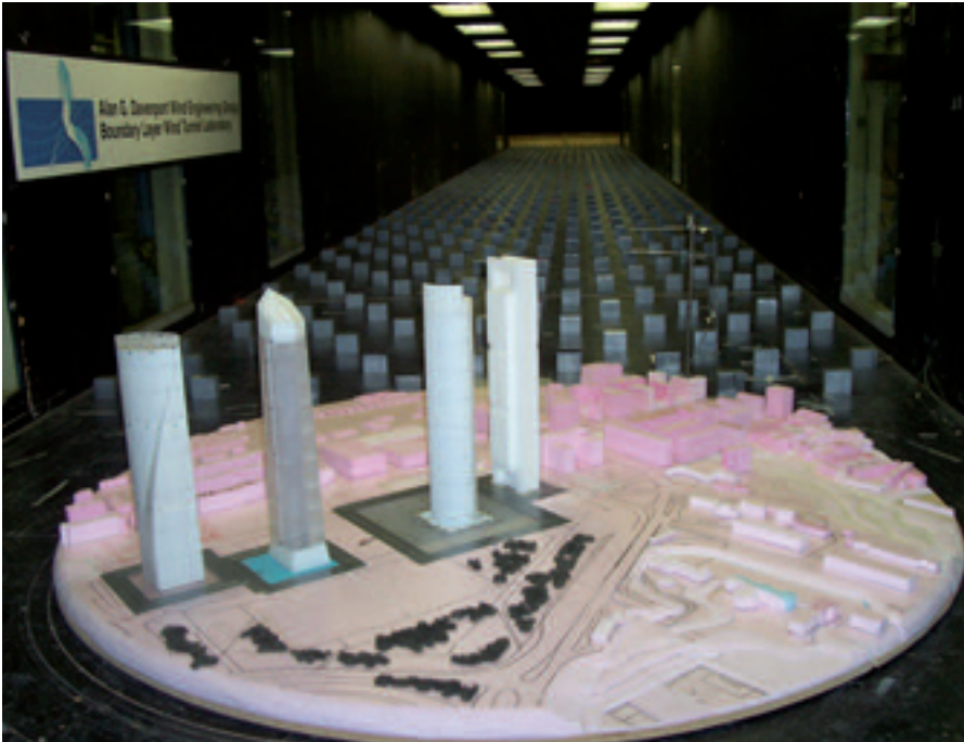
Figura 12. Imagen del ensayo en túnel de viento de la torre, incluyendo las otras tres torres vecinas ensayadas previamente.
