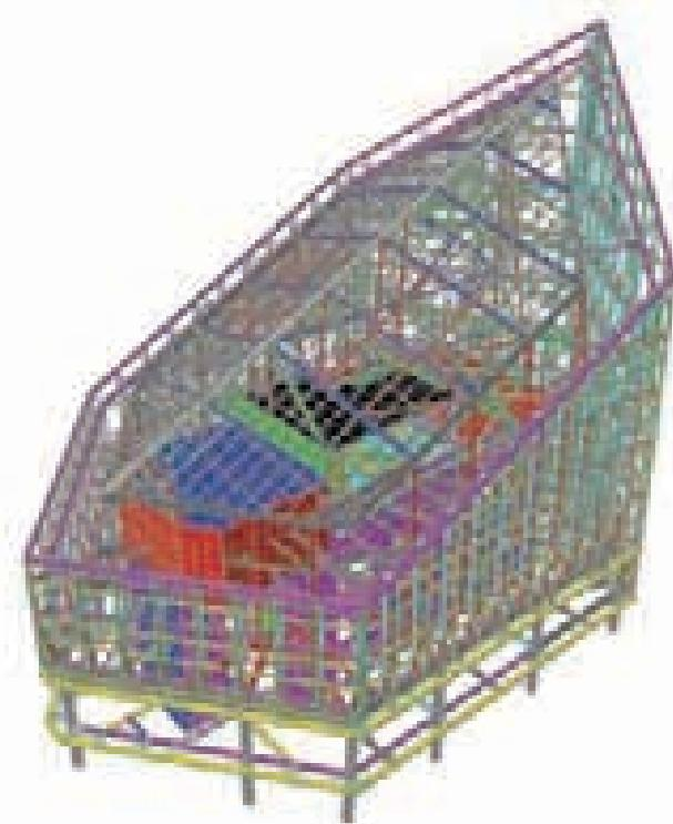
Figura 30. Modelo de la estructura de coronación.
