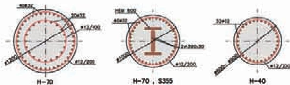
Figura 16. Secciones tipo de los soportes: bajo rasante, zona de accesos a la torre, zonas media y alta.
