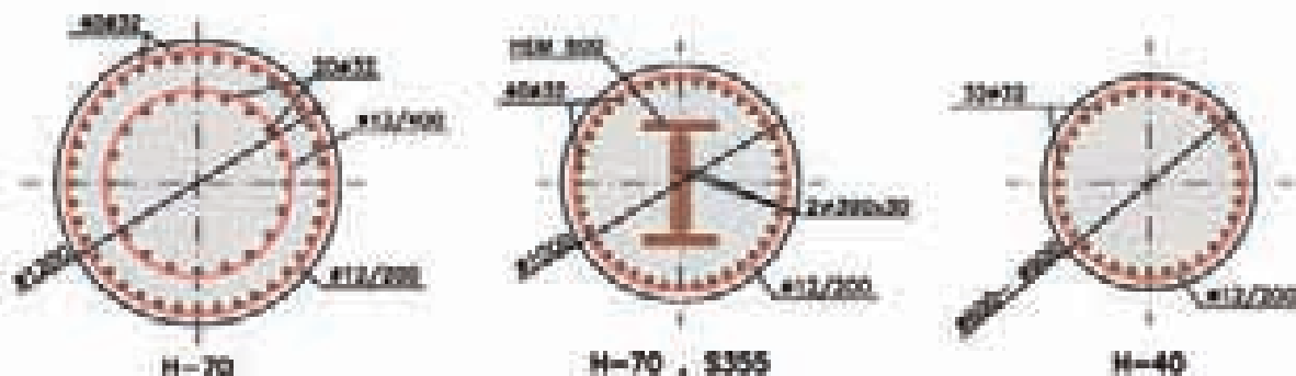
Figura 16. Secciones tipo de los soportes: bajo rasante, zona de accesos a la torre, zonas media y alta. Figure 16. Typical support cross sections: under ground level, tower access areas, mid and high areas.
