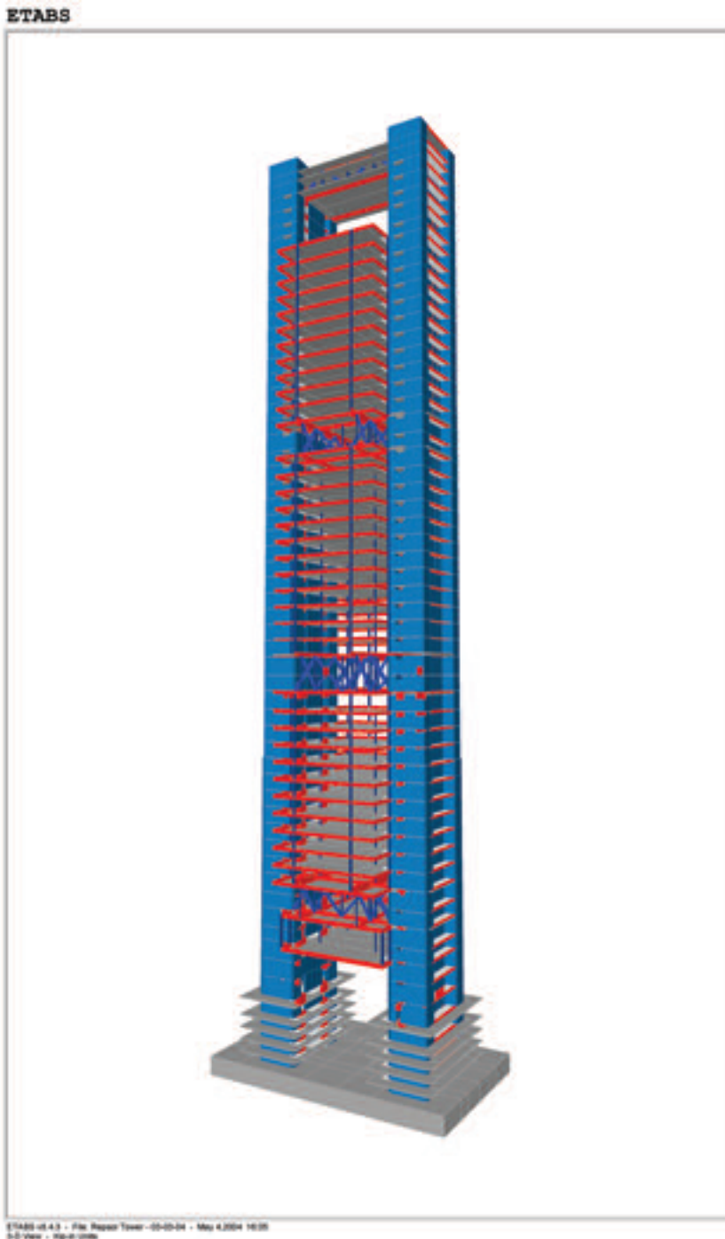
Figura 22. Modelo de análisis del edificio completo mediante ETABS. Figure 22. ETABS full building analysis model.
