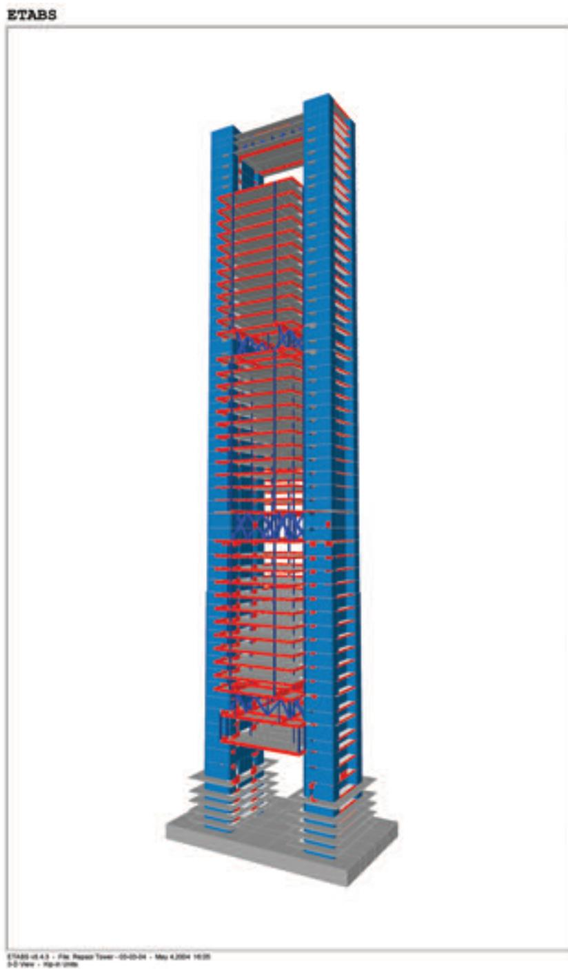
Figura 22. Modelo de análisis del edificio completo mediante ETABS.
