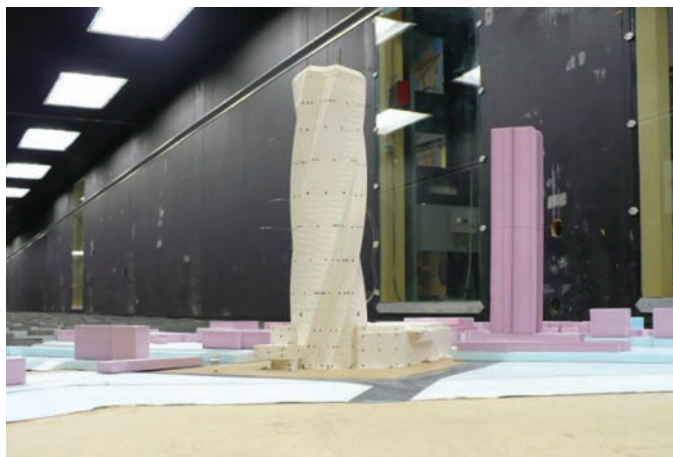
Figura 5. Modelo de presiones. Torre Nueva Marina, Casablanca (O&B 2012 [21]). AA Architects, MC-2, TYPSA.
