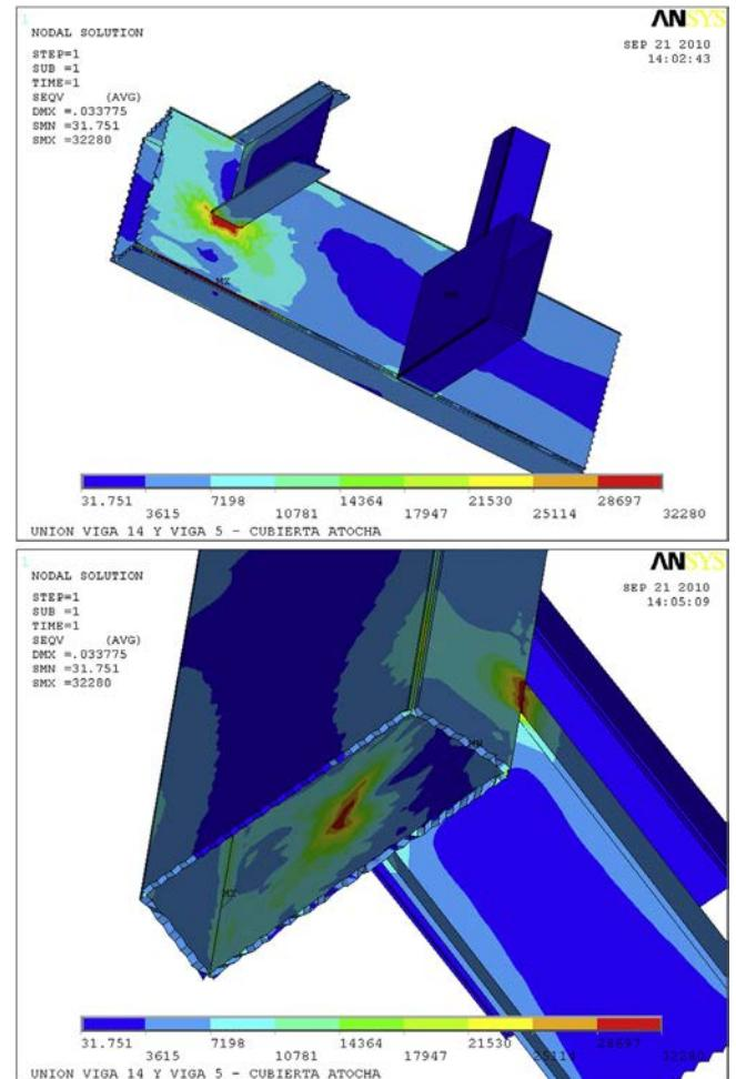
Figura 19. Análisis de un nudo sin rigidización.
