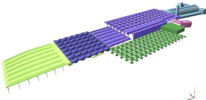
Figura 11. Modelo de cálculo para la simulación numérica de las acciones del viento [9].
