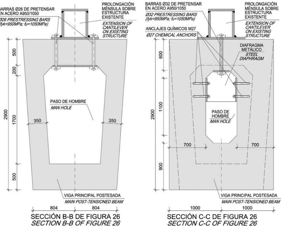
Figura 27. Tramo de prolongación ménsula voladizo by-pass (secciones transversales).
