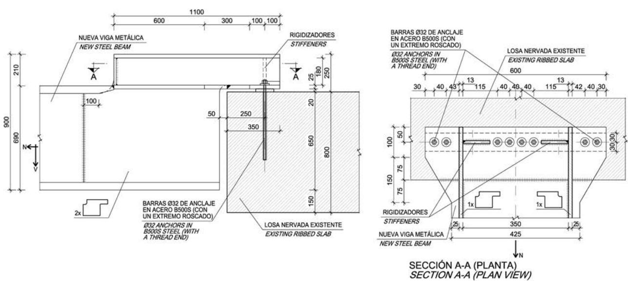
Figura 30. Apoyo a media madera de tipo fijo-articulado.
