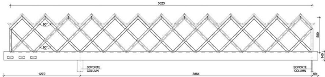
Figura 34. Alzado de la celosía de apoyo.
