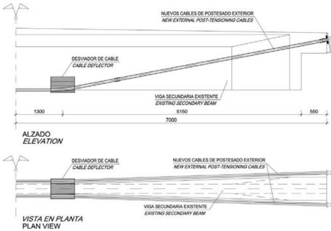
Figura 25. Trazado de cables de postesado exterior.
