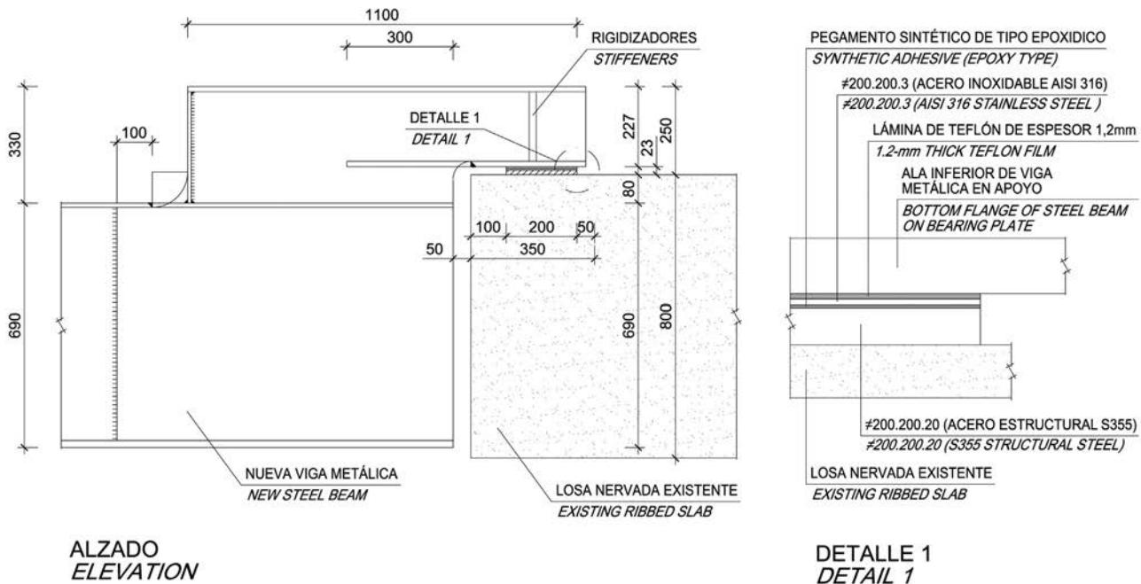
Figura 31. Apoyo a media madera deslizante (alzado).
