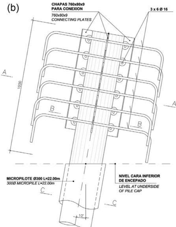
Figura 17. Encepado de la cubierta baja norte con detalle de conexión del micropilote.
