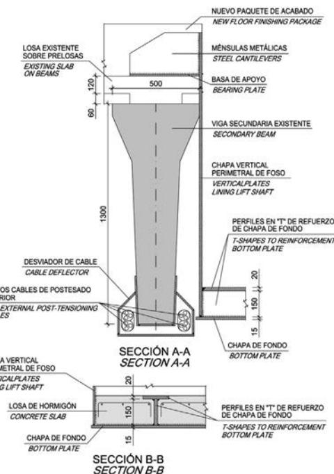
Figura 23. Recinto metálico foso ascensor (planta y sección).
