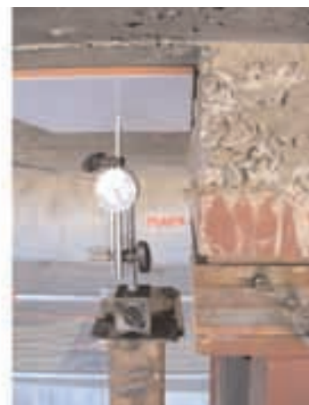
Figura 39. Mecanismo de determinación de la carga en apeos. Micrómetro para determinación de movimientos.
