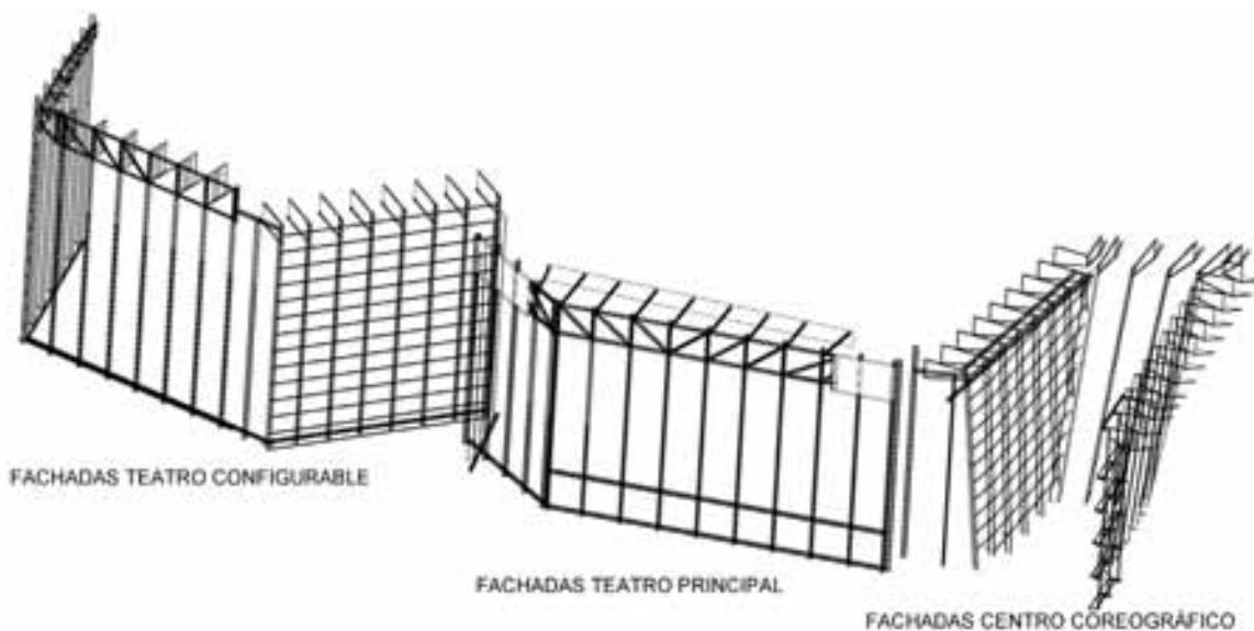
Figura 27. Estructura metálica de las fachadas superiores colgadas.
