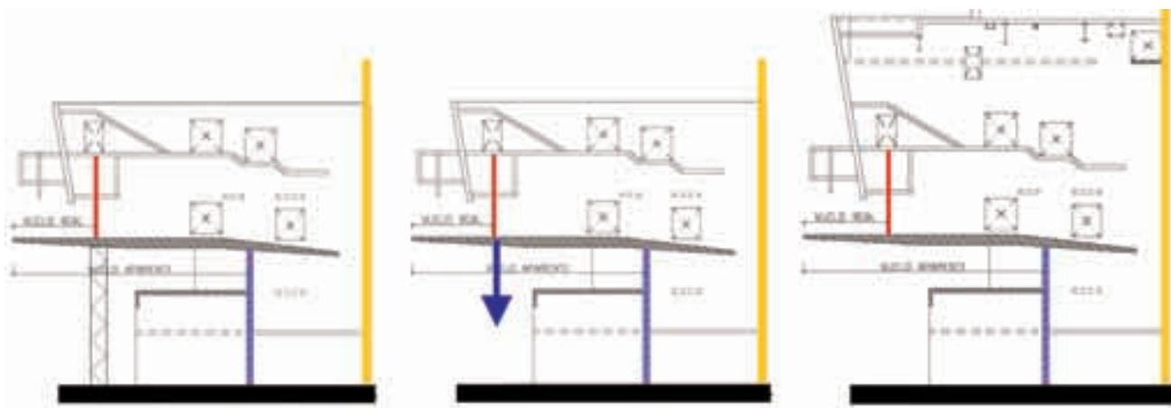
Figura 37. Esquema de fases de la construcción del Teatro Principal: Estructura parcial apeada (izq.), desapeo (cent.) y finalización de la ejecución (dcha.).
