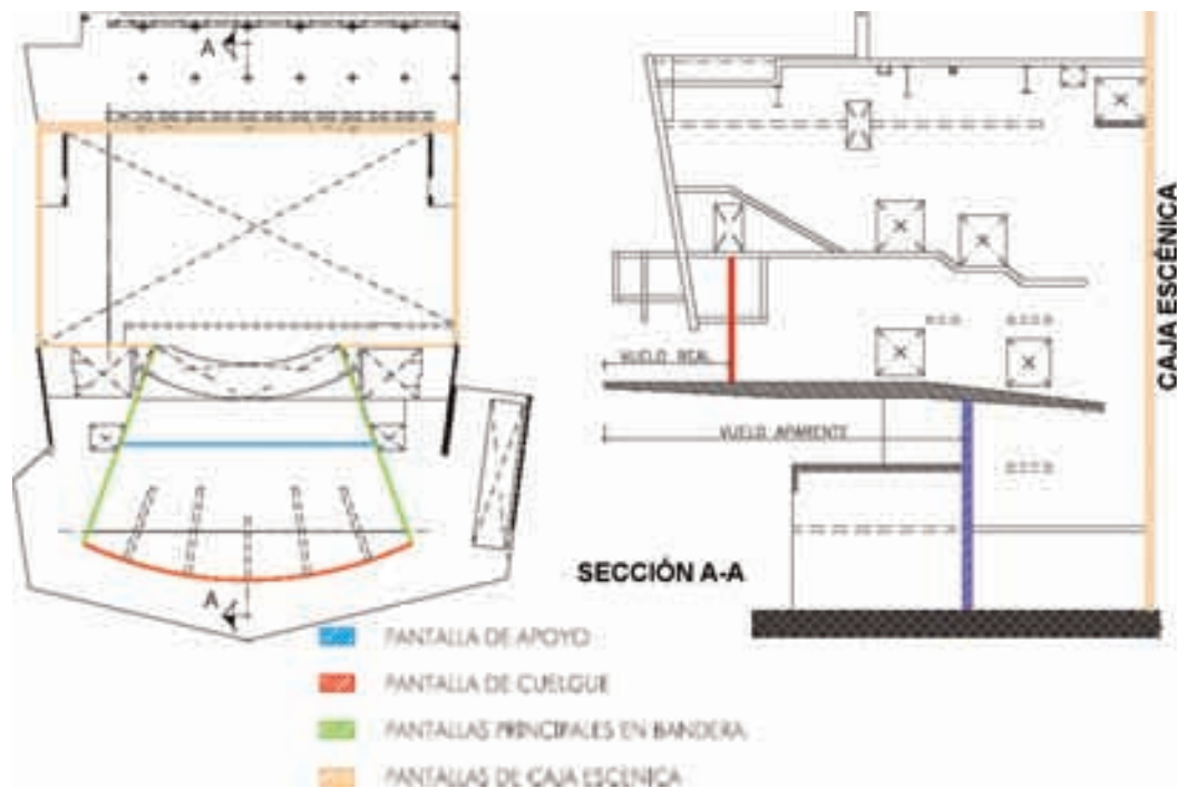
Figura 8. Esquema de la estructura colgada del Teatro Principal. Figure 8. Main theatre hung structures scheme.
