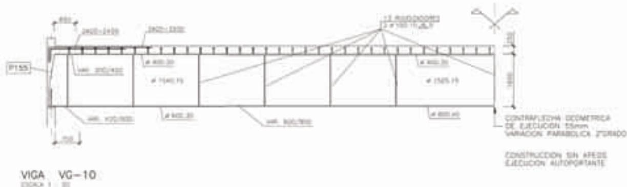
**Figura 15.** Vigas mixtas de soporte del forjado de la sala de ensayos.
