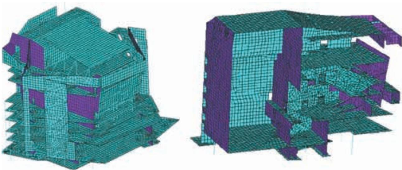
**Figura 33.** Modelos de elementos finitos del Teatro configurable (izq.) y Principal (dcha.).
