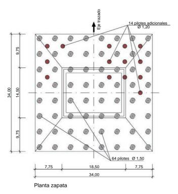
Figura 22. Planta del encepado de la pila 4.
