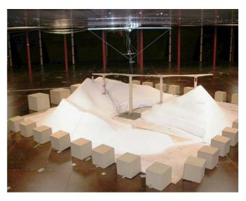
Figura 15. Modelo global del puente en construcción para ensayo de viento.
