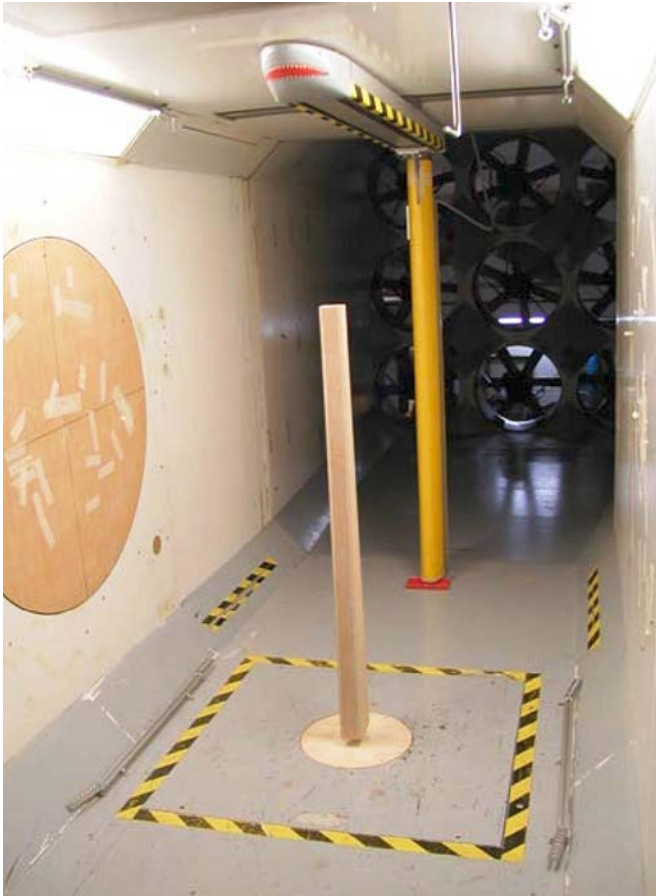
Figura 12. Ensayo de viento seccional de la pila 4.
