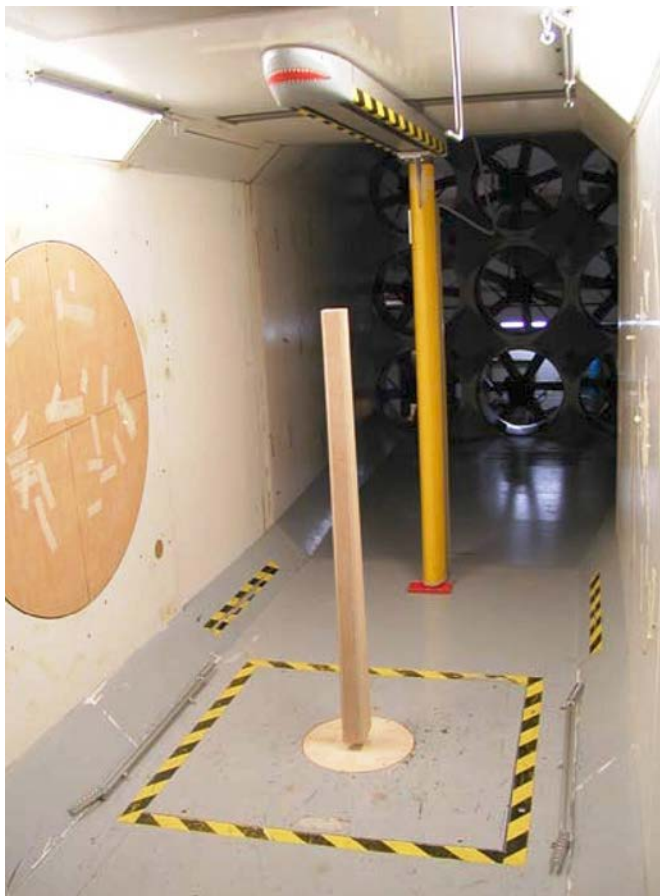
Figura 12. Ensayo de viento seccional de la pila 4.
