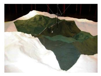
Figura 14. Modelo del terreno para ensayo de viento.
