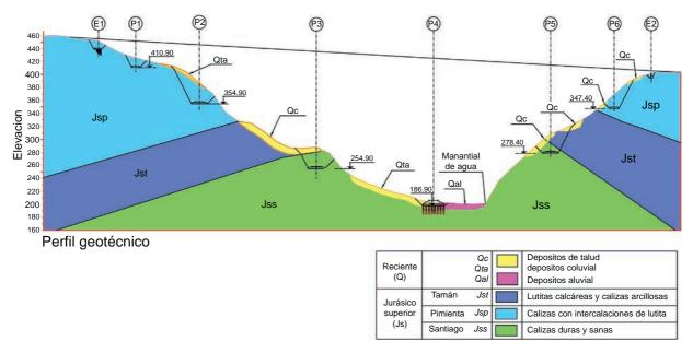
Figura 5. Perfil geotécnico.
