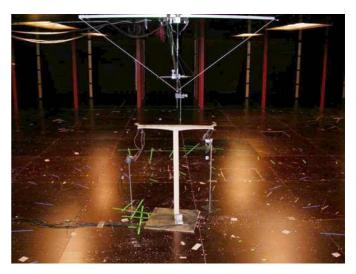
Figura 16. Modelo de una pila aislada para ensayo de viento.
