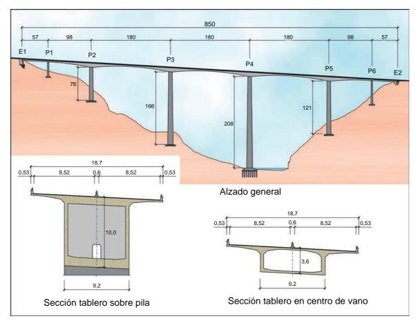
Figura 4. Esquema del puente. Alzado y secciones transversales.
