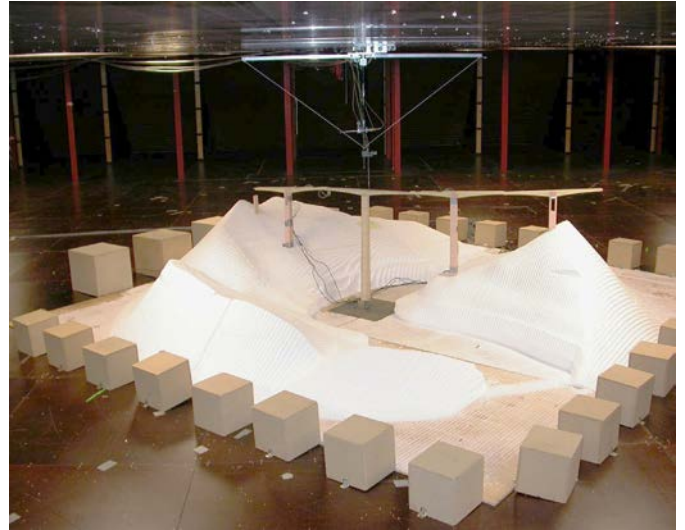
Figura 15. Modelo global del puente en construcción para ensayo de viento.
