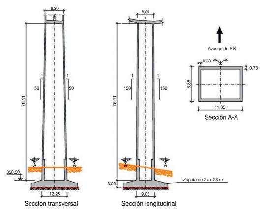
Figura 7. Formas de la pila 2.
