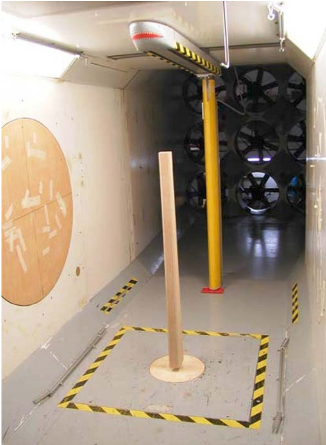
Figura 12. Ensayo de viento seccional de la pila 4.
