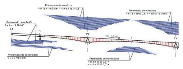
Figura 11. Esquema general del pretensado.
