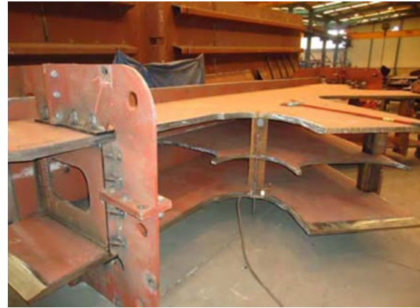
Figura 15. Vista de fabricación de un nudo tumbado.
