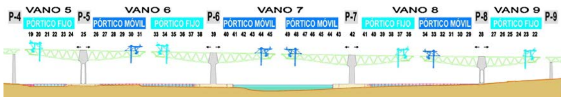
Figura 32. Esquema de división en dovelas de los 5 vanos de canto variable y carros de izado.
