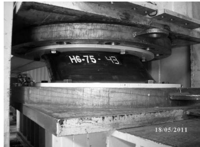
Figura 10. Ensayo dinámico sobre aislador sísmico.
