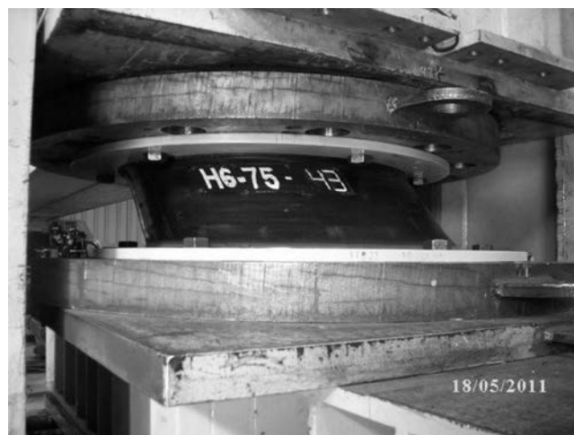
Figura 10. Ensayo dinámico sobre aislador sísmico.
