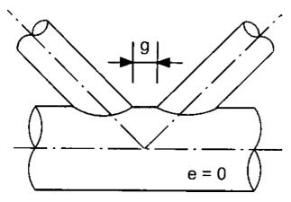
Figura 11. Esquema de nudo con espaciamiento «g» y excentricidad nula (e = 0).
