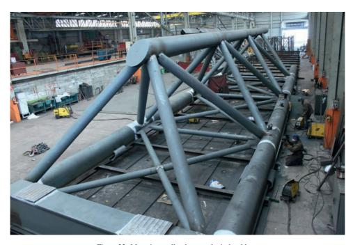
Figura 23. Montaje en taller de una celosía de tablero.
