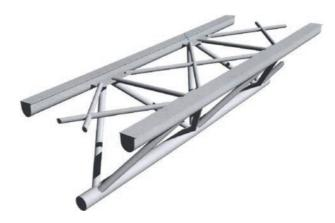
Figura 7. Celosía metálica. Esquema.
