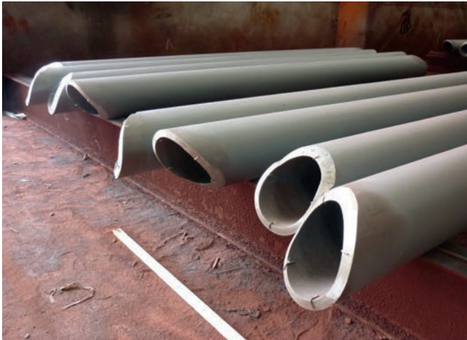
Figura 10. Corte y preparación de bordes en extremos de los tubos que constituyen las diagonales de las celosías.
