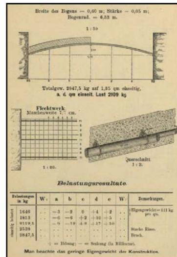
Figura 4. El Depósito de Gijón de Ribera en 1902, y el sistema Monier para las bóvedas.
