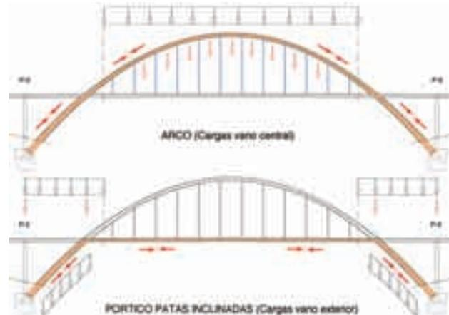
Figura 35A. Solución 3. Esquema resistente para cargas permanentes
