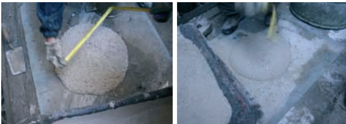
Figura 19. Ensayos de extensión de flujo: a) 13/03/09 y b) 26/06/09. Fuente propia Figure 19. Slump tests: a) 13/03/09 and b) 26/06/09. Source: authors
