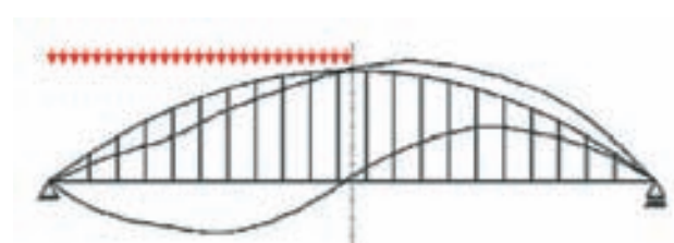
Figura 6. Leyes de momentos flectores en un bowstring con péndolas verticales sometido a sobrecargas asimétricas Figure 6. Bending moment distribution in a bowstring with vertical hangers and non-symmetric live loads
