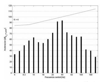
Figura 11. Espectro envolvente de la aceleración en el forjado con manta bajo balasto
