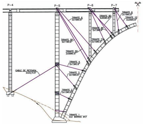
Figura 14. Esquema de atirantamiento provisional
