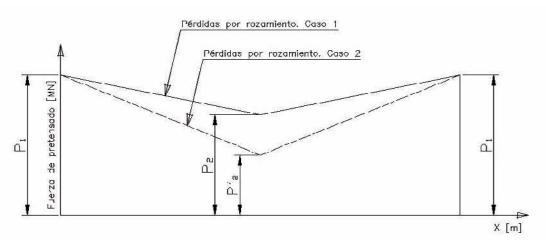
Figura 11. Pérdidas de pretensado para dos parejas de valores de  $\mu$  y  $\beta$
