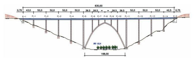
Figura 6. Solución con arco inferior peraltado curvo de 168 m de luz. Solución finalmente seleccionada
