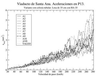
Figura 19. Envolvente de aceleraciones. Composición por trenes
