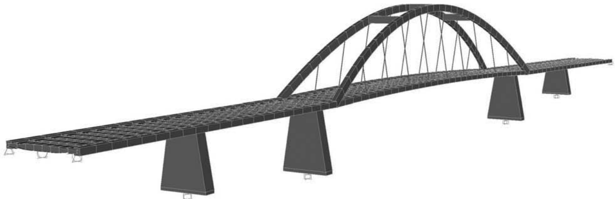
Figura 10. Modelo inicial con placas y vigas sin colaboración de losa. En éste se incluían también las pilas
