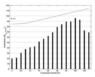
Figura 18. Espectro de aceleración en la base de la cimentación. Escenario: v = 6 m/s; k = 20 kN/mm;
