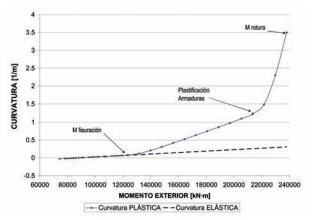
Figura 6. Curvaturas en sección transversal cajón
