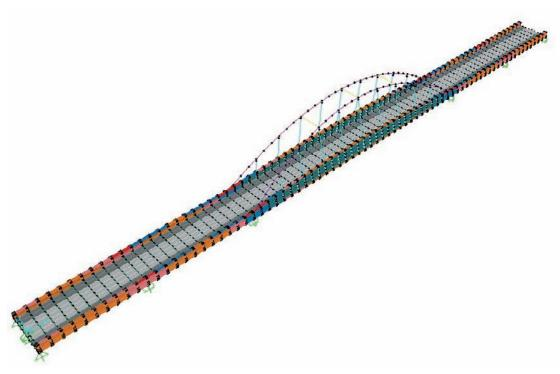
Figura 13. Solución inicial modelizada mediante elementos tipo lámina. Modelo completo
