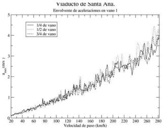
Figura 20. Envolvente de aceleraciones en puntos del vano 1
