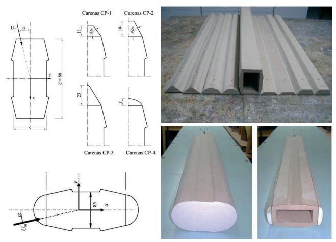
Figuras 16a a 16d. Análisis de carenados para pilas
