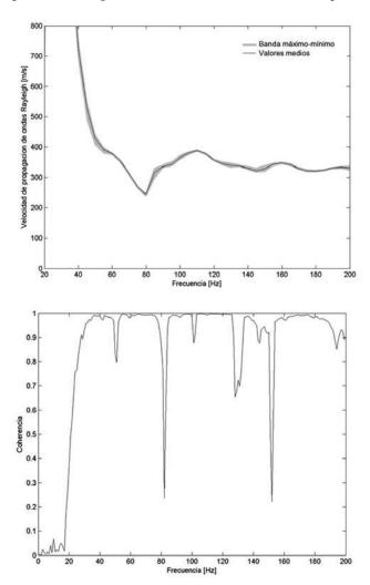
Figura 3. Curvas de dispersión de todos los golpes y función de coherencia
