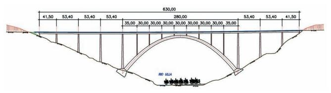
Figura 7. Solución alternativa con arco inferior rebajado curvo de 280 m de luz
