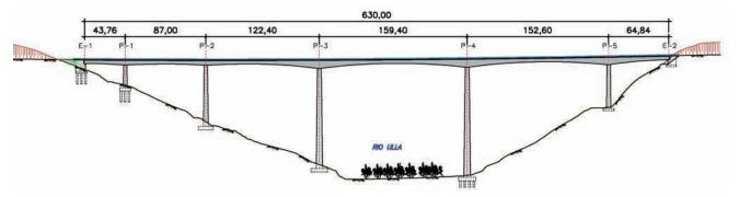
Figura 4. Solución alternativa de voladizos sucesivos con 159,4 m de luz central
