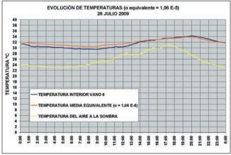
Figuras 19a y 19b. Correlación prácticamente perfecta entre la temperatura media equivalente de la sección mixta (ajustada con  $\alpha$ \*=1,06·10<sup>-5</sup> °C<sup>-1</sup> para este caso) y la temperatura del aire en el interior de la sección cerrada
