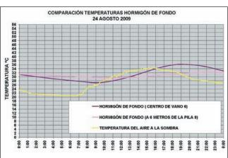
Figuras 14a y 14b. HF Correlación prácticamente perfecta entre la temperatura media equivalente
