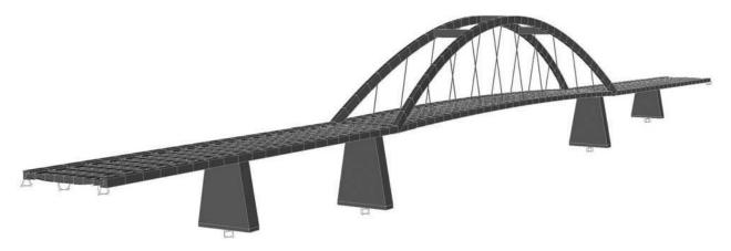
Figura 10. Modelo inicial con placas y vigas sin colaboración de losa. En éste se incluían también las pilas
