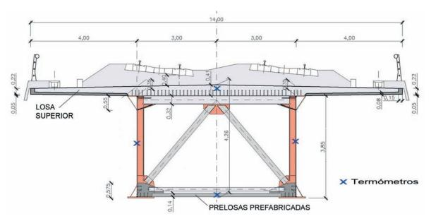
Figura 2. Posición de sensores de temperatura en la sección del centro del vano 6
