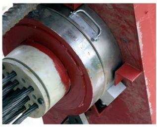
Figura 24. Célula de carga en anclaje pasivo de un tirante
