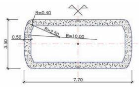
Figura 9. Sección tipo del arco en tramo superior
