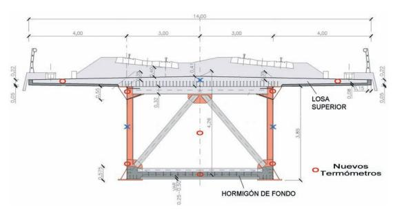
Figura 12. Incremento de sensores de temperatura en la losa superior, el hormigón de fondo, las vigas metálicas, y el interior del cajón (temperatura ambiente interior)
