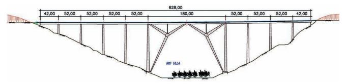
Figura 5. Solución alternativa con arco inferior peraltado poligonal de 170 m de luz
