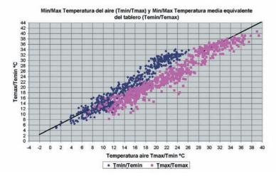
Figura 17. Relación entre  $T_{max}/T_{min}$  del aire a la sombra (eje de abscisas) y  $T_{e,max}/T_{e,min}$  temperaturas equivalentes máximas y mínimas diarias de la sección mixta (eje de ordenadas). Comparación con la propuesta de EN-1991-1-5 [4].
