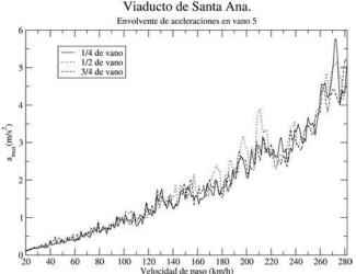
Figura 24. Envolvente de aceleraciones en puntos del vano 5
