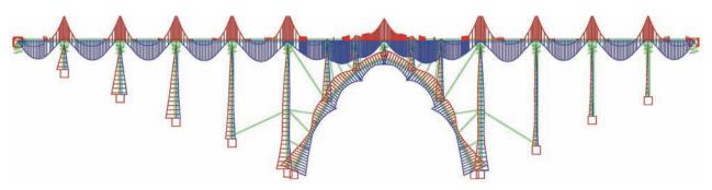
Figura 19. Envolventes de cálculo de momentos flectores en ELU
