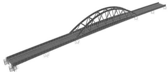
Figura 18. Modelo con celosía tubular. Vista 3D
