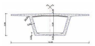
Figura 10. Sección tipo del tablero
