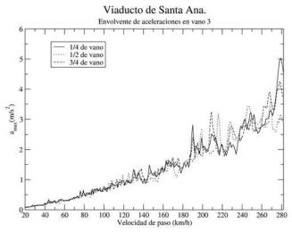
Figura 22. Envolvente de aceleraciones en puntos del vano 3
