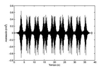
Figura 17. Historia de aceleraciones en la base de la cimentación. Escenario: v = 6 m/s; k = 20 kN/mm;
