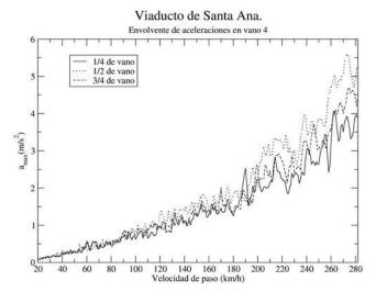
Figura 23. Envolvente de aceleraciones en puntos del vano 4
