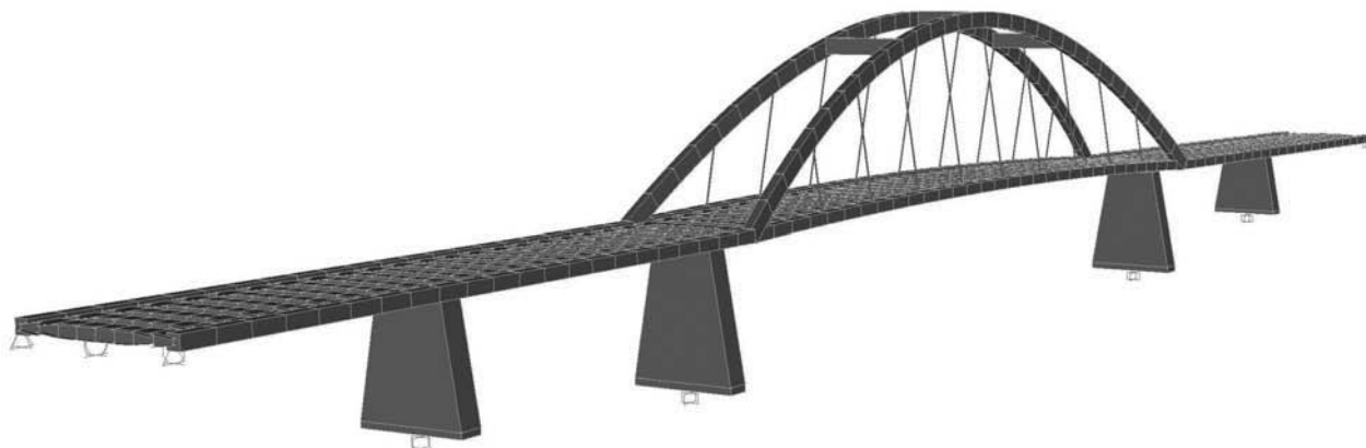
Figura 10. Modelo inicial con placas y vigas sin colaboración de losa. En éste se incluían también las pilas
