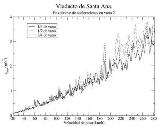
Figura 21. Envolvente de aceleraciones en puntos del vano 2
