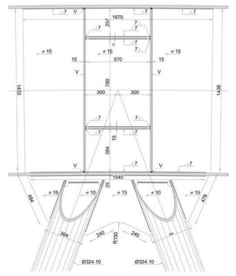
Figura 5. Detalle de nudo entre arco superior y diagonales tubulares
