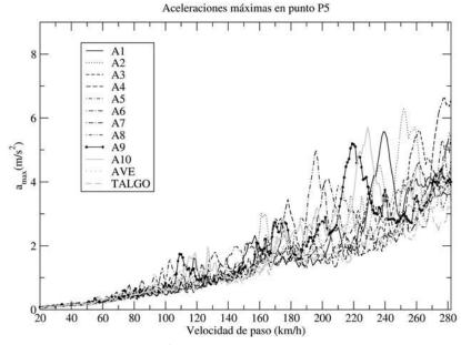
Figura 15. Aceleraciones máximas en punto crítico
