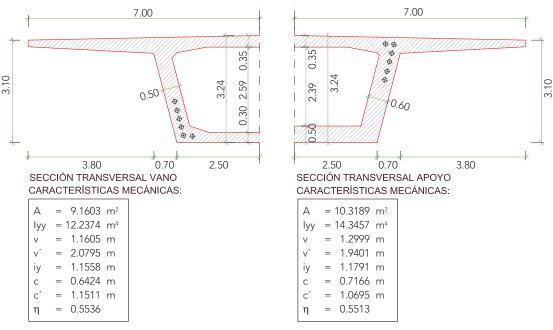
Figura 2. Sección transversal tipo cajón
