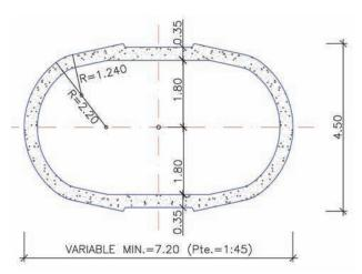
Figura 13. Sección tipo de pilas principales
