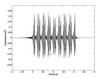
Figura 6. Historia temporal de aceleración durante el paso de un Velaro E a 350 km/h
