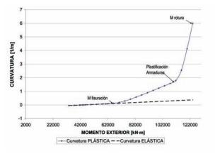
Figura 5. Curvaturas en sección transversal losa
