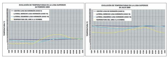
Figuras 13a y 13 b. Evolución de temperaturas de la losa. Voladizos y centro bajo el balasto
