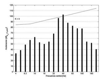
Figura 9. Espectro envolvente a nivel del forjado
