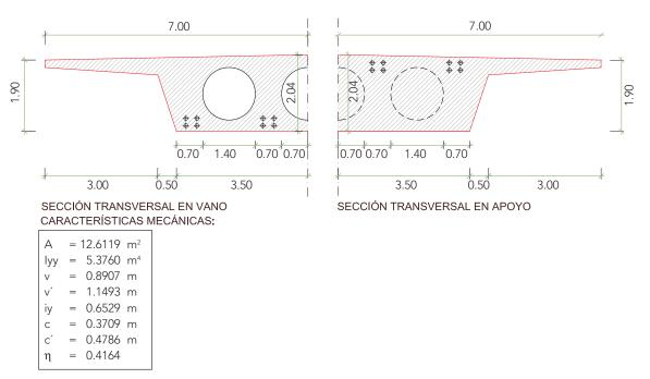
Figura 1. Sección transversal tipo losa aligerada
