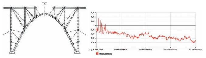
Figuras 27a y 27b. Registros del sistema robotizado de seguimiento topográfico
