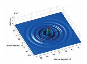
Figura 5. Función de transferencia Gzz(x,y,ω) para 40 Hz
