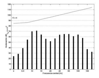
Figura 19. Espectro de aceleración en la celosía. Escenario: v = 6 m/s; k = 20 kN/mm; Tren Velaro E
