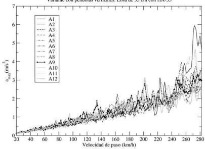
Figura 16. Envolvente de aceleraciones en punto crítico para última alternativa con péndolas cuasi-verticales
