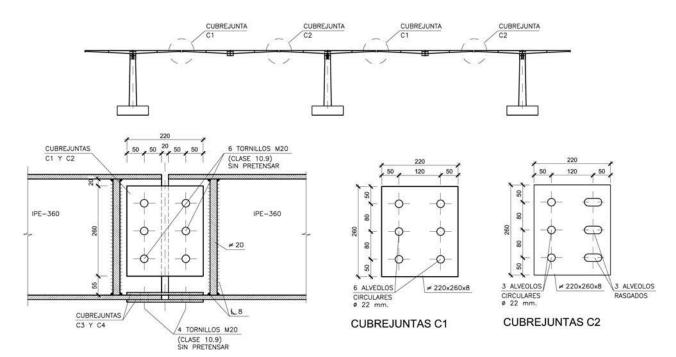
Figura 6. Unión atornillada entre módulos
