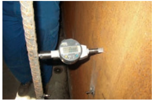
Figura 17. Control de deformaciones transversales en el alma
