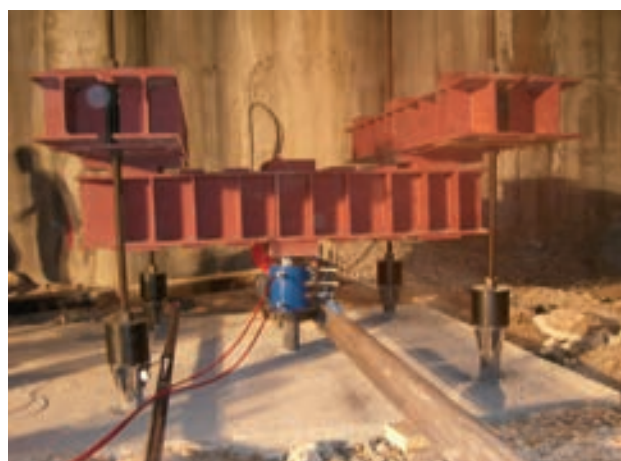
Figura 36. Prueba de carga de micropilote
