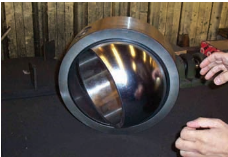
Figura 48. Rótula esférica de bulón pasante, antes de su montaje en la zona inferior del arco Figure 48. Radial spherical plain bearing, before fitting in bottom arch area.
