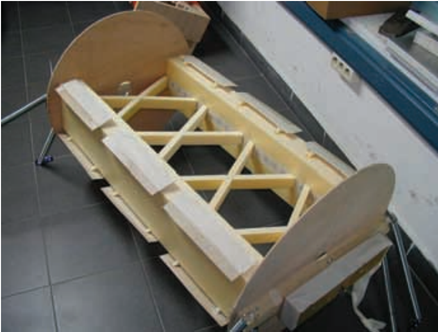
Figura 60. Modelo provisto de deflectores. Figure 60. Guide vane fitted model.
