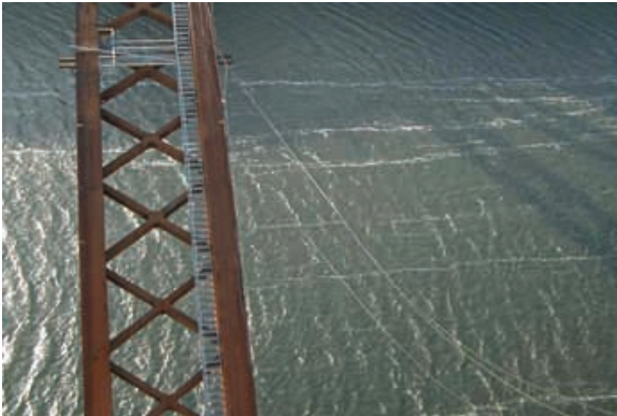
Figura 56. Estelas sobre la superficie del agua del embalse provocadas por viento estacionario Figure 56. Wakes on the reservoir's water surface caused by stationary wind.
