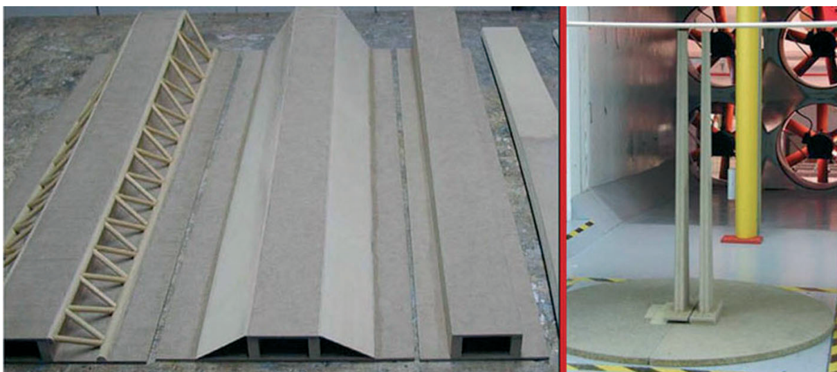
Figura 8. Modelos reducidos para ensayo en túnel de viento Figure 8. Scale models used on the wind tunnel tests
