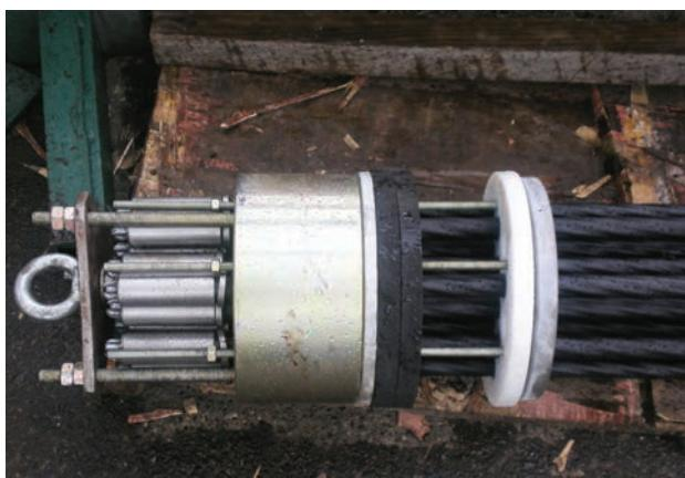
**Figura 27.** Nuevo anclaje superior con manguitos
