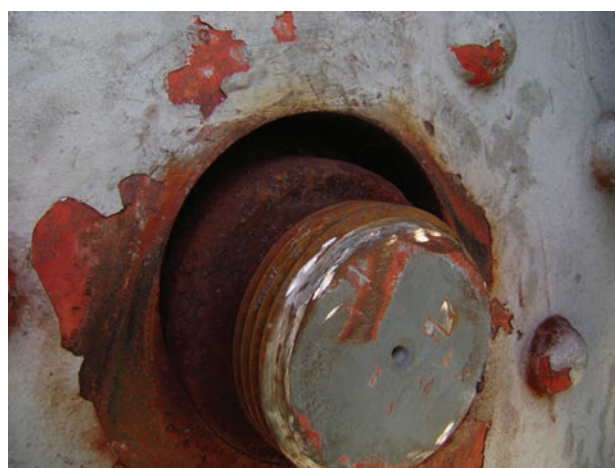
Figura 15. Estado original de los bulones de 5" Figure 15. 5" pins original condition
