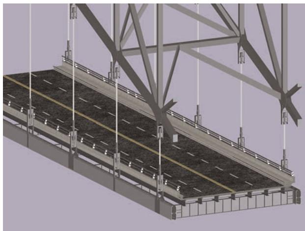
**Figura 4.** Perspectiva del tablero con las nuevas péndolas
