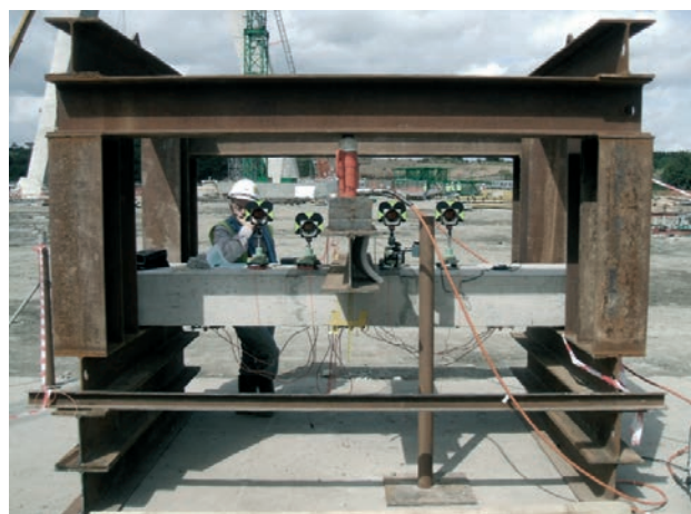
Figura 25. Ensayo de flexión en tres puntos de una junta de tablero Figure 25. Three point bending test of a deck slab joint
