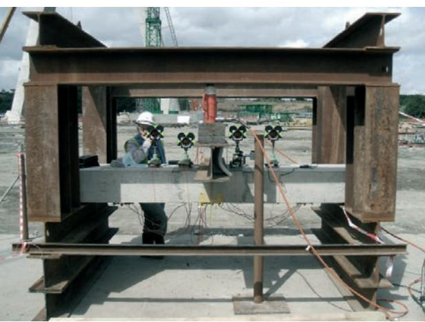
**Figura 25.** Ensayo de flexión en tres puntos de una junta de tablero
