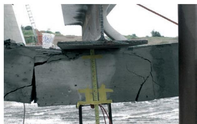
Figura 27. Junta entre losas prefabricadas después del ensayo.
