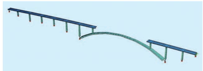
Estructura tras el desapeo de pilas provisionales Structure after the dismantling of temporary piers
