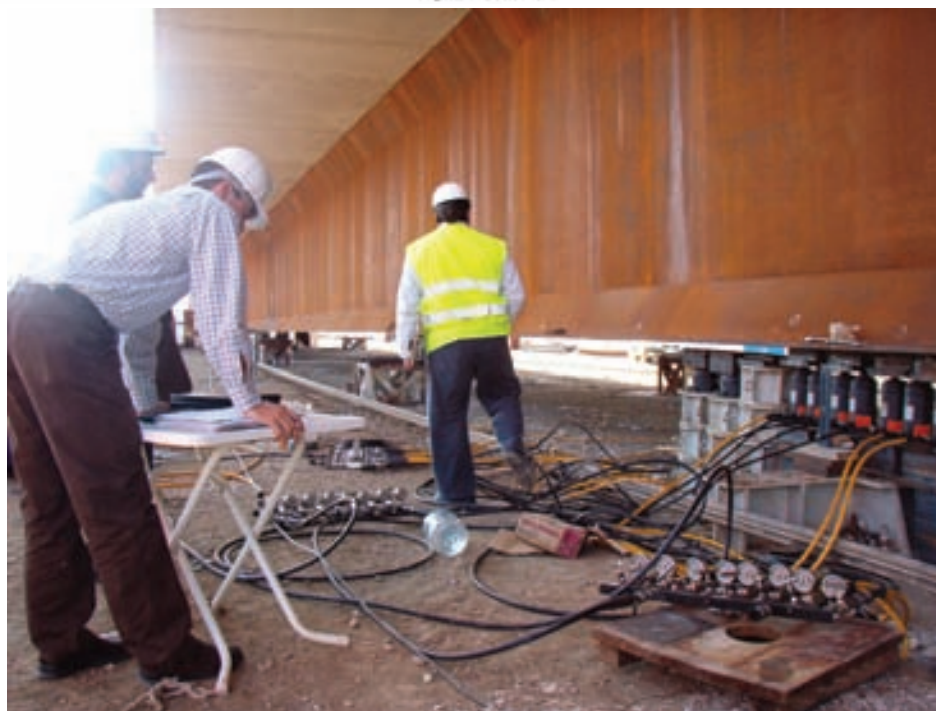
Fig. 28. Medida de la rigidez transversal. Fig. 28. Measuring cross stiffness.
