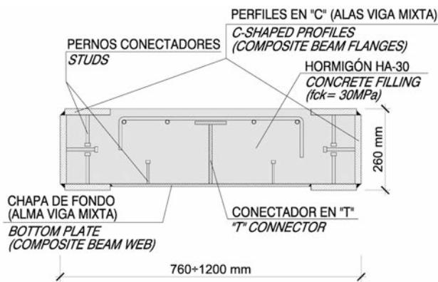
Figura 16. Sección transversal viga de patio
