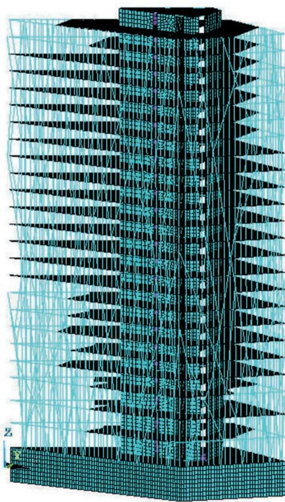
**Figura 9.** Modelo de EF tridimensional de la estructura global
