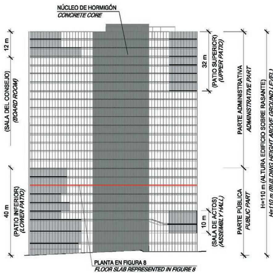
Figura 4. Distribución interna del edificio (alzado)
