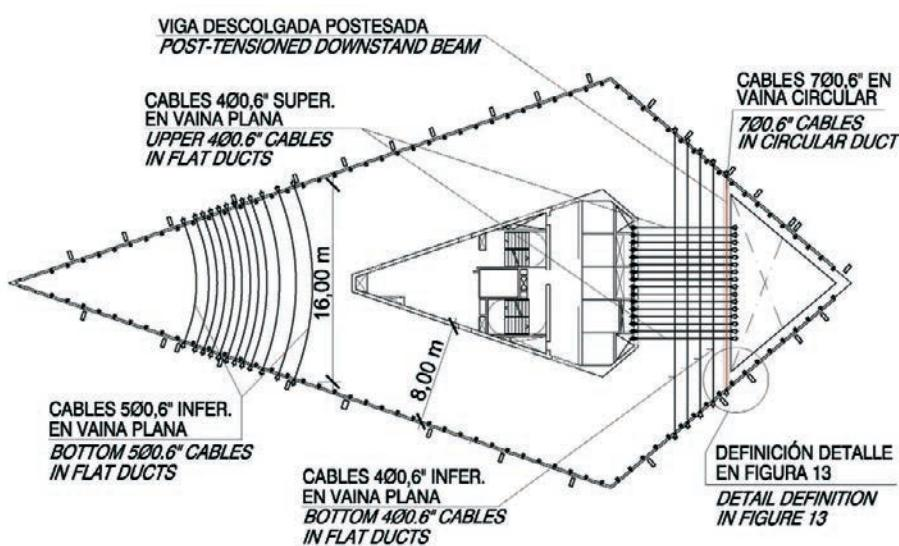
**Figura 10.** Cables de postesado en la 22<sup>a</sup> planta
