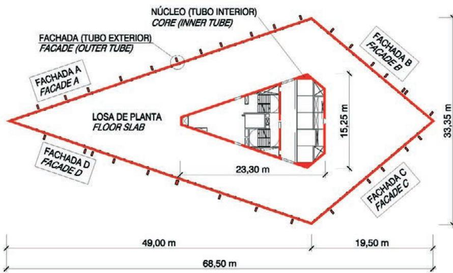
**Figura 6.** Esquema estructural de la tipología "tubo en tubo"
