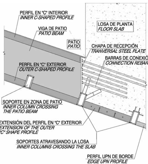
Figura 18. Planta de la continuidad entre viga de patio y losa
