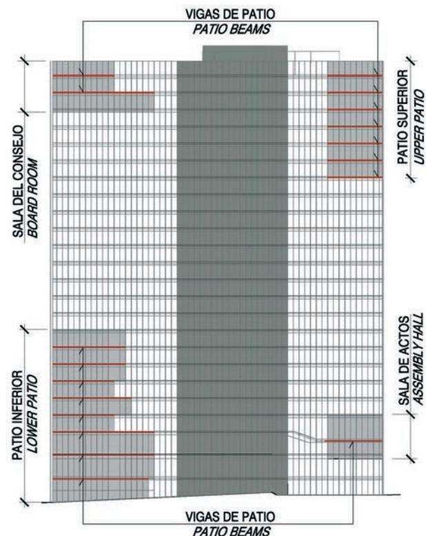
Figura 15. Esquema disposición de vigas de patio
