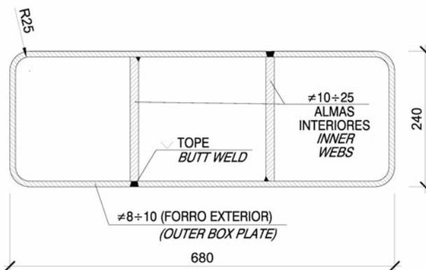
Figura 22. Sección transversal bambú (cotas en mm)
