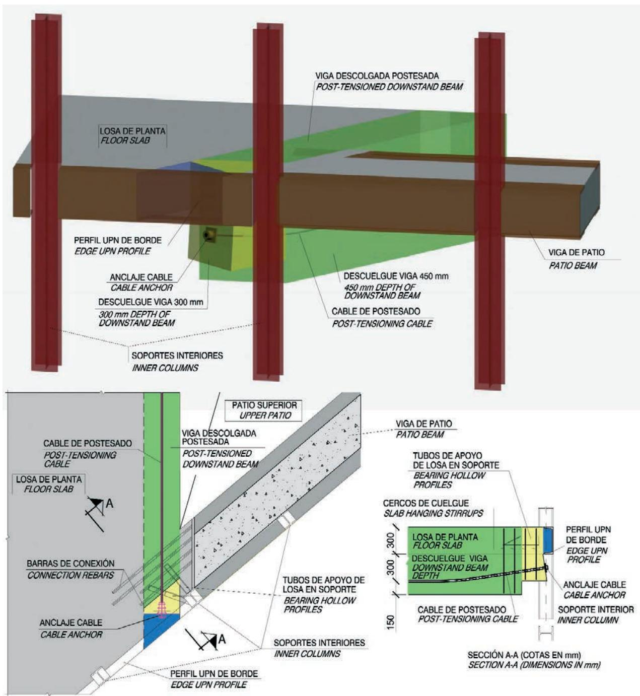
**Figura 13.** Detalle de apoyo de viga descolgada postesada en soporte metálico y encuentro con viga de patio
