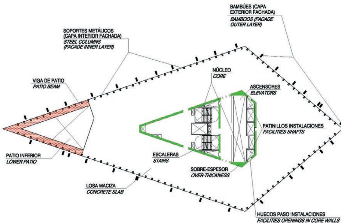
Figura 8. Planta tipo de un forjado de patio
