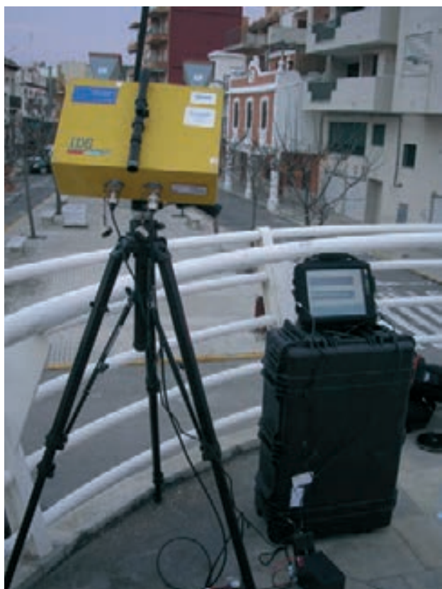
Figura 11. Radar interferométrico empleado, junto con la tableta de adquisición de resultados
