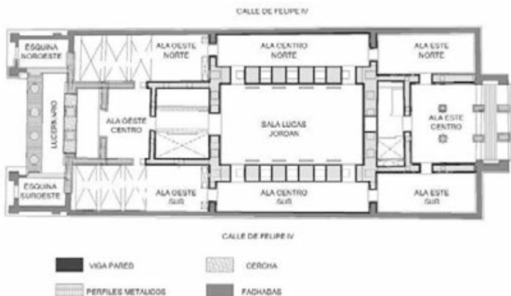
Figura 3. Soluciones estructurales por zonas
