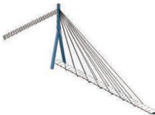
Figura 12. Modelo numérico empleado para la evaluación estructural
