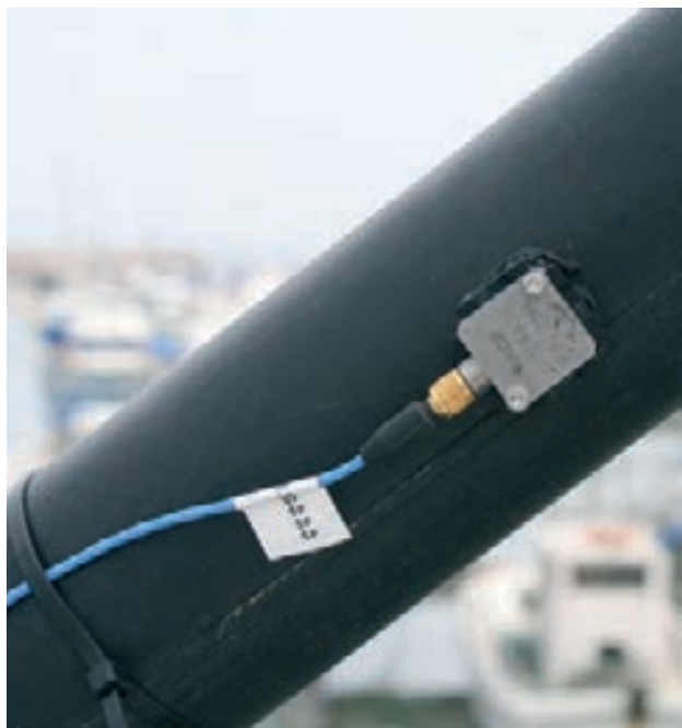
Figura 10. Acelerómetro MEMS empleado
