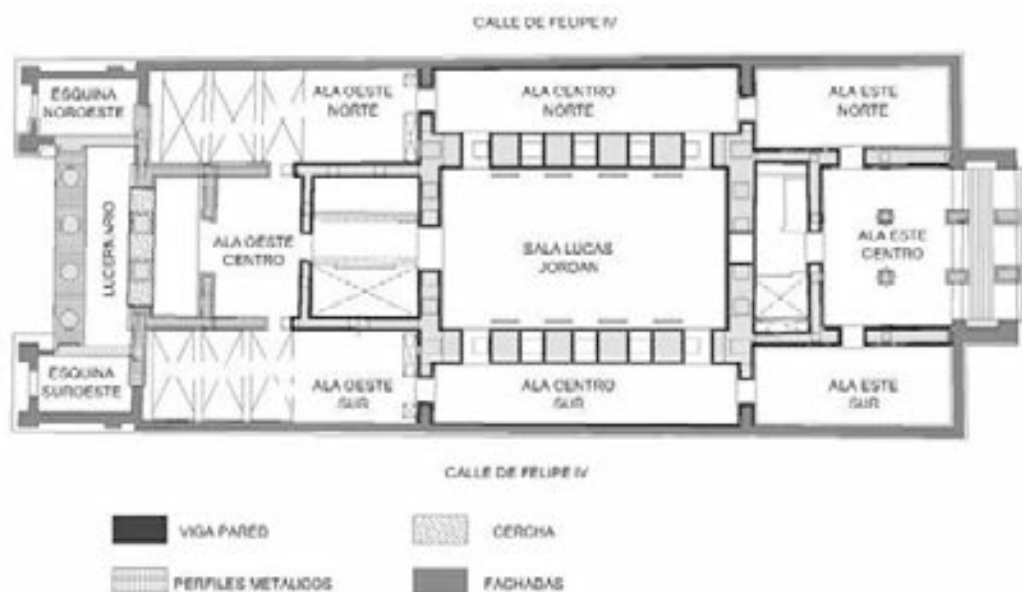
Figura 3. Soluciones estructurales por zonas
