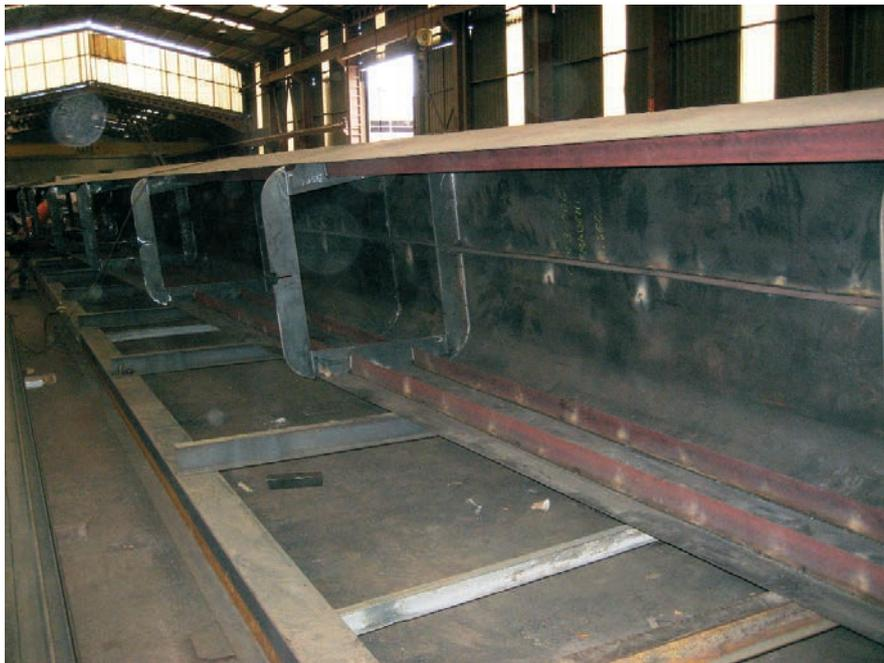
Figura 22. Costilla móvil durante su fabricación en el taller
