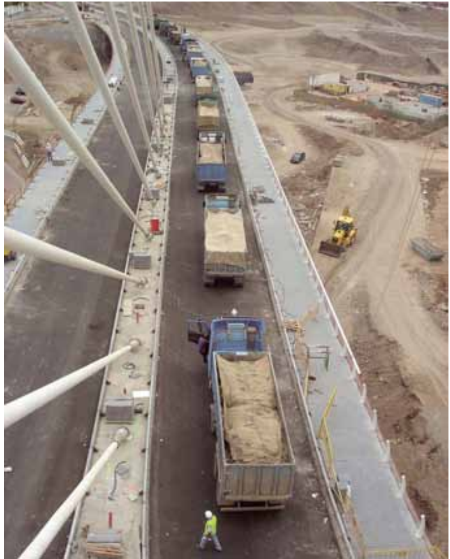
Figura 38. Prueba de carga estática. Hipótesis de torsión. Figure 38. Static loading test (torsion hypothesis)
