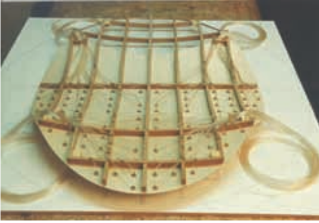
Figura 29. Vista de la cara inferior del modelo de la cubierta donde se aprecian las tomas de presión. Figure 29. View of the lower side of the roof model, where the pressure taps can be seen.
