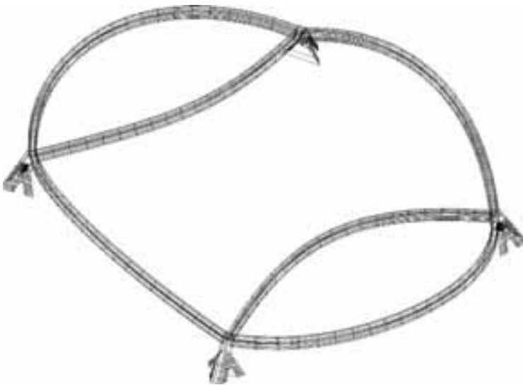
Figura 23. Esquema de los bordes de la malla y su conexión a los soportes. Figure 23. Diagram of the perimeter of the mesh and its connection to the supports.
