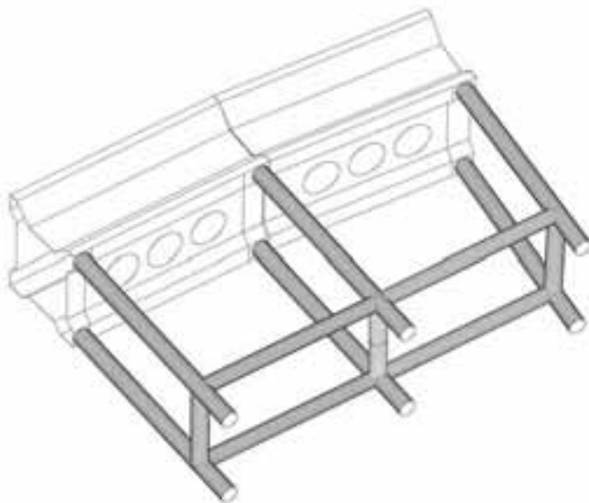
Figura 26. Sección de los cajones interior y de borde. Figure 26. Section of the interior and edge caissons.
