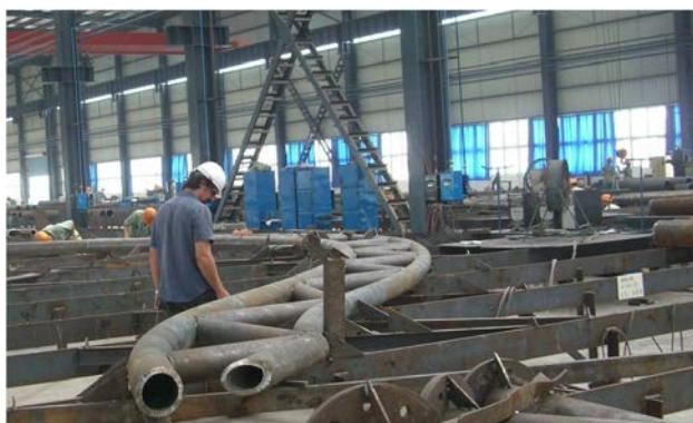
Figura 35. Celosía vertical en construcción
