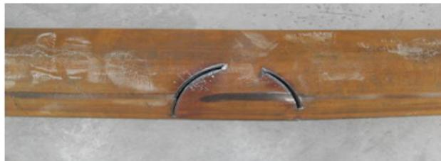
Figura 33. Corte parcial automático sobre el tubo recto
