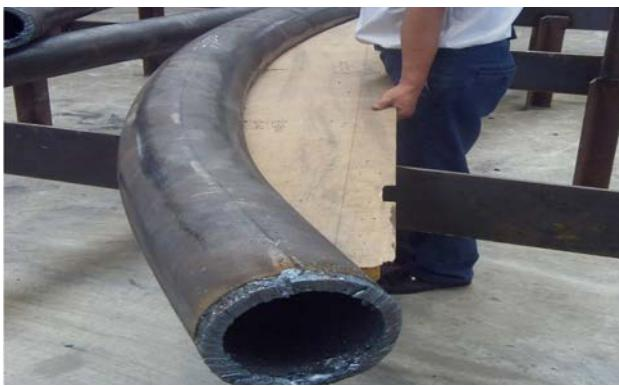
Figura 32. Comparación de tubo curvado con una plantilla de madera
