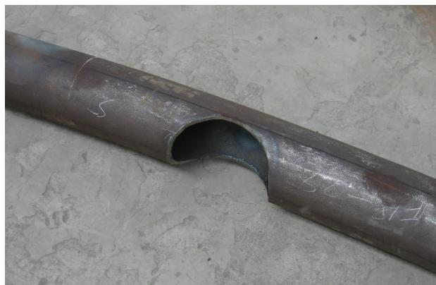
Figura 34. Corte completado con soplete sobre el tubo curvo
