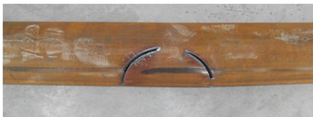
Figura 33. Corte parcial automático sobre el tubo recto Figure 33. Automatic partial cut on straight tube
