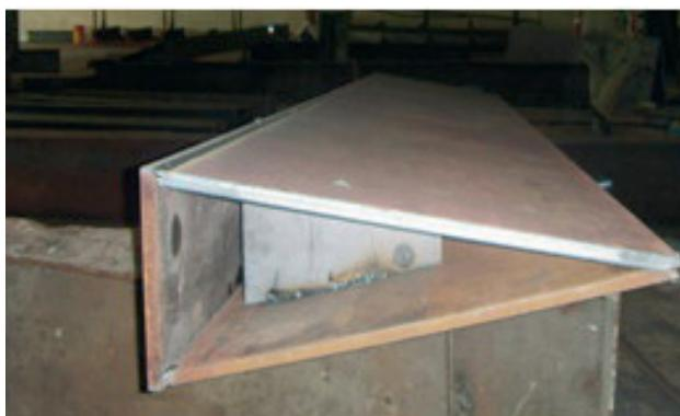
**Figura 19.** Viga triangular en construcción en taller (tumbada)
