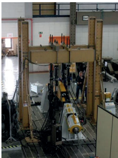
Figura 4. Ensayo de fatiga de la silla.
