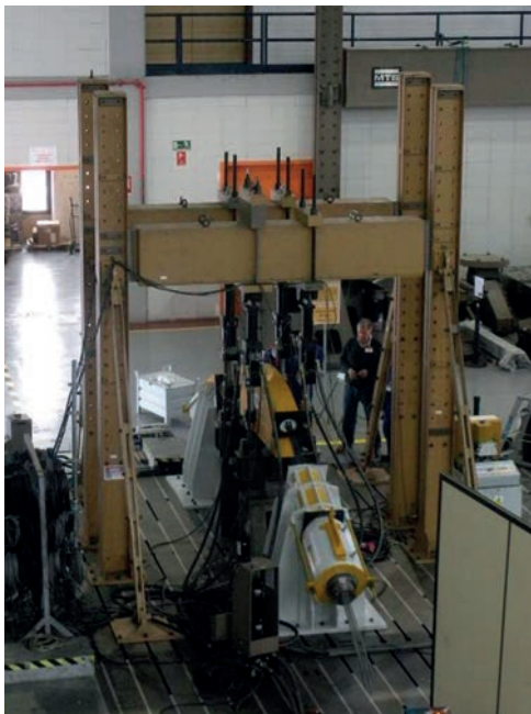
Figura 4. Ensayo de fatiga de la silla.
