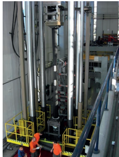
Figura 5. Ensayo de fatiga y rotura de tirante.
