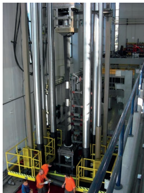
Figura 5. Ensayo de fatiga y rotura de tirante.
