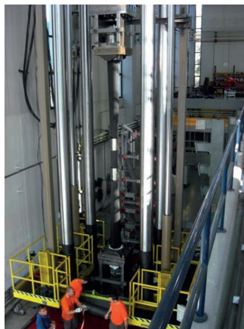
Figura 5. Ensayo de fatiga y rotura de tirante.
