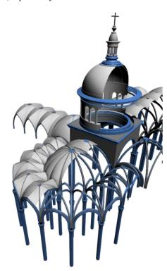
Los hormigones autocompactantes sin armaduras metálicas, reforzados con fibras de polipropileno en el caso de las láminas, no solamente son la base para evitar que se repitan los problemas de durabilidad en el futuro, sino, además, resultaron imprescindibles para la realización de la estructura espacial, geométricamente compleja.
